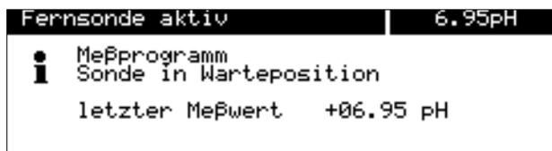
Wenn das Meßprogramm parametriert wurde, befindet sich die Sonde normalerweise in der Spülkammer und fährt beim Start des Programms zur Messung in den Prozeß. Nach Ablauf der parametrierten Meßzeit fährt die Sonde zurück in die Spülkammer, wo die Elektrode gespült, gereinigt und kontrolliert werden kann und verhardt dort, bis das Meßprogramm erneut gestartet wird.
