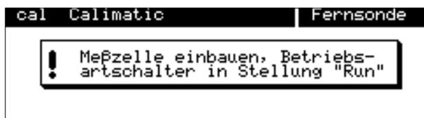
Nach Beendigung der Kalibrierung und Wiedereinbau der Elektrode fordert Sie das Gerät auf, den Betriebsartschalter in Stellung "Run" zu bringen. Kontrollieren Sie vorher nochmals, ob die Elektrode ordnungsgemäß eingebaut und die Wechselarmatur betriebsbereit ist (Druckluft, Wasser, Reinigungsmittel, ...).
