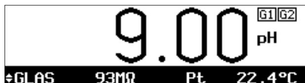
Wenn die parametrierten **Grenzwerte**, z. B. beim pH-Meßwert, über- oder unterschritten werden, erscheint rechts oben im Display "G1" und/oder "G2".
