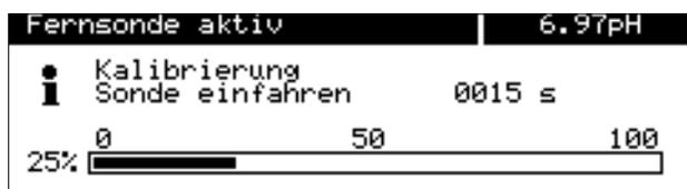
Schalten Sie dann den Betriebsartschalter in Stellung "Run". Die Wechselarmatur führt daraufhin die restlichen Programmschritte aus und fährt in Stellung "Messen".
