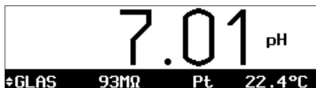
Im **Meßmodus** erlaubt das Grafikdisplay sowohl die simultane Darstellung des aktuellen Meßwertes in großen Ziffern (25 mm) und von zwei weiteren Werten in Nebenanzeigen, als auch von NAMUR-gerechten **Statusmeldungen** wie **Warnung** (Wartungsbedarf) und **Ausfall** sowie von Grenzwertmeldungen.
