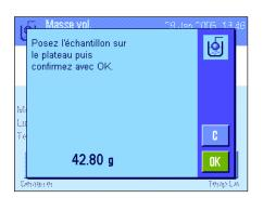
Pressez la touche de fonction "**Démarrer**" pour démarrer la détermination de la masse volumique. La balance effectue un tarage automatique puis il vous est demandé de poser le corps solide (première pesée dans l'air).
