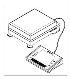
Le terminal est relié à la balance par un câble. Afin que vous puissiez agencer votre poste de travail de manière optimale, le terminal peut être séparé de la plate-forme de pesage et être placé individuellement.
