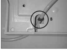
Refermez les deux moitiés de boîtier jusqu'à ce que la bague de retenue (B) soit positionnée dans le passage de câble de la partie inférieure du boîtier.
