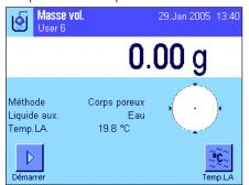
Dans les paramétrages spécifiques à l'application, sélectionnez la méthode **"Corps poreux"** (chapitre 13.3.2) et déterminez le liquide auxiliaire voulu (chapitre 13.3.3).
