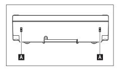
Pour modifier l'angle de lecture, enfoncez les deux boutons (A) qui se trouvent à l'arrière du terminal. Vous pouvez maintenant basculer la partie supérieure du boîtier vers le haut ou le bas , jusqu'à ce qu'elle se bloque dans la position souhaitée. 3 positions sont disponibles.
