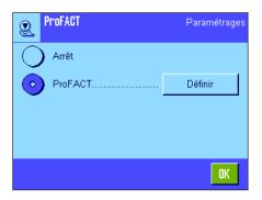
Dans ce menu, vous définissez les paramétrages pour le réglage automatique avec le poids **interne** de réglage (ProFACT). ProFACT (**Pro**fessional **F**ully **A**utomatic **C**alibration **T**echnology) règle la balance automatiquement sur la base de critères temps et/ou température présélectionnés.
