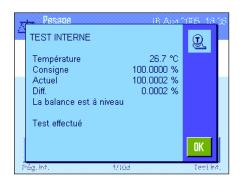
La réussite du contrôle est confirmée par la fenêtre ci-contre. Si une imprimante est raccordée à la balance, le contrôle est automatiquement imprimé conformément aux paramétrages système pour le compte rendu (chapitre 6.3.7). Vous trouverez un modèle de compte rendu dans le chapitre 8.4.6.
