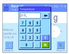
Si vous utilisez l'**eau ou l'éthanol comme liquide auxiliaire**, entrez sa **température** via la touche de fonction "**Temp. LA**" (pour ces deux liquides, des tables de masse volumique sont mémorisées dans la balance pour la plage de température de 10 °C à 30°C, voir aussi les chapitres 13.7 et 13.8). L'illustration ci-contre montre le champ d'entrée correspondant (entrée en °C avec 1 décimale).
