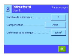
"**Nbre de décimales**":Le résultat de la détermination de la masse volumique peut être affiché et imprimé avec 1 à 5 décimales.
