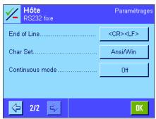
**Important:** Afin que les caractères spéciaux (p. ex. "°C") soient correctement imprimés sur les imprimantes METTLER TOLEDO, la **balance et l'imprimante** doivent être paramétrées avec **8 bits de données**.
