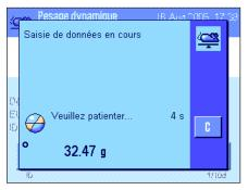
Posez le produit à peser. Le poids du produit doit être supérieur à celui affiché dans le champ d'information "Dém. Auto", sinon le cycle de pesage n'est pas démarré automatiquement. Après le démarrage automatique, la fenêtre ci-contre apparaît.
