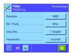
Si vous avez activé un appareil, vous pouvez paramétrer via le bouton "Définir" les paramètres d'interface pour la communication avec cet appareil, autrement dit, la vitesse de transmission, le format de données, les bits d'arrêt, le contrôle de flux, les caractères de fin de ligne, le jeu de caractères et "Continuous mode" (uniquement pour le périphérique "Hôte").
