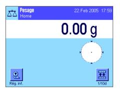
**Mise en marche de la balance:** Mettez la balance en marche par une brève pression de la touche «**On/Off**». Lors de la mise en marche, la balance charge le dernier profil utilisateur utilisé et l'application qui était active à l'instant de la mise à l'arrêt. Les désignations de l'application et du profil utilisateur apparaissent dans le coin supérieur gauche de l'écran.
