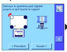
Dévissez le pied réglable jusqu'à ce qu'il repose "légèrement" sur le support.
