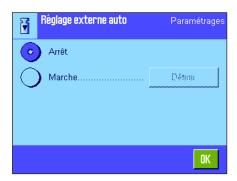
Si vous travaillez avec un poids externe de réglage, vous pouvez définir ici quels jours de la semaine et à quelle heure, la balance doit vous rappeler de réaliser le réglage. Vous trouverez des informations sur le déroulement d'un réglage (automatique) avec un poids externe de réglage, dans le chapitre 8.4.3.
