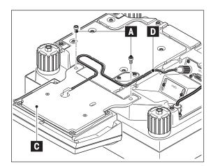
Le terminal est relié à la balance par un câble. Afin que vous puissiez agencer votre poste de travail de manière optimale, le terminal peut être séparé de la plate-forme de pesage et être placé individuellement.
