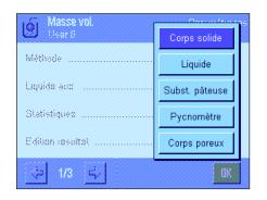
"Corps solide": Détermination de la masse volumique de corps solides non poreux
