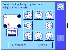
Pressez le bouton correspondant à la position de la bulle d'air dans le niveau à bulle.
