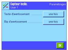
Si le capteur d'inclinaison est activé, vous pouvez, après pression du bouton "**Définir**", définir si et à quelle fréquence un texte d'avertissement et/ou un bip d'avertissement correspondant doit être émis, lorsque la balance n'est pas exactement de niveau.
