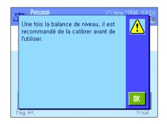
Avant que la balance ne retourne au mode pesage, un message s'affiche et recommande de régler la balance après la mise de niveau. Confirmez le message avec "**OK**".
