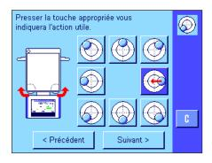
Observez le niveau à bulle de votre balance (celui-ci est éclairé lorsque le capteur d'inclinaison est activé) et pressez le bouton correspondant à la position actuelle de la bulle d'air dans le niveau à bulle. L'assistant de mise de niveau vous indique ensuite à l'aide de flèches rouges le sens dans lequel vous devez tourner les deux pieds réglables (repère "B" sur l'illustration ci-dessus).
