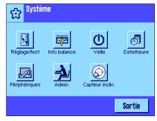
**Modification de paramétrages système:** Si vous souhaitez modifier les paramétrages système qui sont valables pour tout le système de pesage ou pour tous les profils utilisateur et applications, pressez la touche « value », puis le bouton "**Système**". Les paramétrages système sont décrits en détail dans le chapitre 6.
