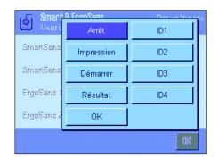
"**Démarrer**" et "**Résultat**" émulent les touches de fonction de même nom. "**OK**" émule une pression sur le bouton de même nom dans les dialogues de détermination de la masse volumique (toutefois pas dans les menus) pour la confirmation d'entrées et d'actions.
