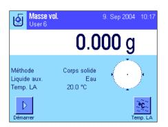
Après sélection de l'application, l'écran ci-contre apparaît. D'origine, des touches de fonction spéciales et champs d'information sont activés pour la détermination de la masse volumique. La balance est préparamétrée pour la détermination de la masse volumique de corps solides avec l'utilisation du liquide auxiliaire eau. Vous pouvez adapter ces paramétrages à vos besoins, conformément à la description dans les chapitres suivants.
