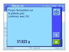
Pressez la touche de fonction "**Démarrer**", pour démarrer la détermination de la masse volumique. Ensuite, il vous est demandé de poser l'échantillon (sans sphère gamma). Le poids de l'échantillon apparaît dans le coin inférieur gauche de la fenêtre.
