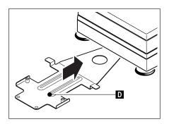
Poussez le porte-terminal (D) par devant, sous la plate-forme de pesage, jusqu'à ce qu'il s'encliquète manifestement.
