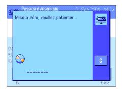
Dès que vous retirez le produit pesé, l'affichage est automatiquement remis à zéro (si la fonction "Tarage automatique" est activée) puis la balance est prête pour la pesée suivante.
