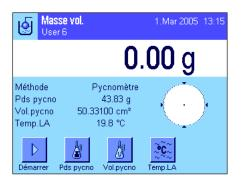
Dans les paramétrages spécifiques à l'application, sélectionnez la méthode "**Pycnomètre**" (chapitre 13.3.2).
