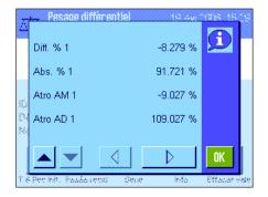
Si les résultats d'un échantillon s'étendent sur plusieurs fenêtres, vous pouvez à l'aide des touches de défilement dans le coin inférieur gauche de la fenêtre passer d'une fenêtre de résultats à l'autre.
