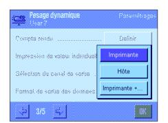
"Imprimante": Les données sont transmises à l'imprimante conformément
