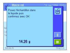
La balance vous demande maintenant de plonger le corps solide imbibé d'huile dans le liquide auxiliaire.
