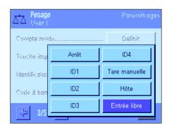
"Arrêt": Aucune donnée de code à barres n'est traitée. Ce paramétrage doit être utilisé si aucun lecteur de codes à barres n'est raccordé.
