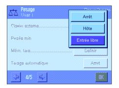
"Arrêt": Aucune entrée au clavier n'est traitée. Ce paramétrage doit être
