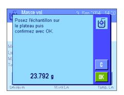
Pressez la touche de fonction "**Démarrer**" pour démarrer la détermination de la masse volumique. La balance réalise un tarage automatique puis il vous est demandé de poser le corps solide (pesée dans l'air).
