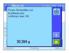
Pressez la touche de fonction "**Démarrer**", pour démarrer la détermination de la masse volumique. Il vous est demandé d'installer le plongeur (pesée dans l'air pour tarage).
