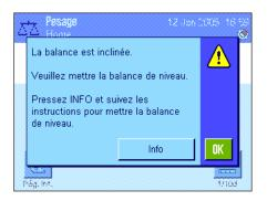
Lorsque le capteur d'inclinaison constate une mise de niveau incorrecte, le texte d'avertissement ci-contre apparaît et un signal acoustique se fait entendre. De plus, une icône d'état correspondante apparaît dans le coin supérieur droit (en dessous de l'heure) de l'écran.
