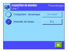
Avec le réglage **"Comportement dynamique"** la balance décide en fonction de vos consignes (réglages des filtres) de la validation ou non du résultat de pesage:
