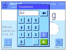
Si vous utilisez **l'eau ou l'éthanol comme liquide auxiliaire**, entrez sa **température** via la touche de fonction "**Temp. LA**" (pour ces deux liquides, des tables de masse volumique sont mémorisées dans la balance pour la plage de température de 10 °C à 30°C, voir aussi les chapitres 13.7 et 13.8). L'illustration ci-contre montre le champ de saisie correspondant (entrée en °C avec 1 décimale).
