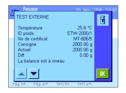
Après réussite du contrôle, la fenêtre ci-contre apparaît. Si une imprimante est raccordée à la balance, le contrôle fait automatiquement l'objet d'un compte rendu imprimé conformément aux paramétrages système pour le compte rendu (chapitre 6.3.7). Vous trouverez un modèle de compte rendu dans le chapitre 8.4.6.
