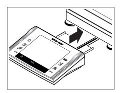
Posez le terminal au milieu du porte-terminal et poussez-le contre la plate-forme de pesage, jusqu'à ce que le terminal bascule légèrement vers le bas.
