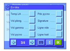
**Temp. LA**": Est imprimée la température de liquide auxiliaire (pour l'eau et l'éthanol) entrée via la touche de fonction de même nom.
