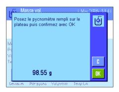
Pressez la touche de fonction "**Démarrer**" pour démarrer la détermination de la masse volumique. Ensuite, il vous est demandé de poser le pycnomètre rempli (le poids sélectionné du pycnomètre apparaît dans le coin inférieur gauche de la fenêtre avec signe négatif).
