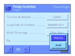
"Arrêt": La fin d'une pesée dynamique n'est pas confirmée par un signal
