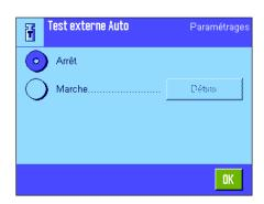
Si vous souhaitez contrôler des réglages à l'aide d'un poids externe de test, vous pouvez définir ici quels jours de la semaine et à quelle heure, la balance doit vous rappeler de réaliser le contrôle. Vous trouverez des informations sur le déroulement d'un contrôle (automatique) du réglage à l'aide d'un poids externe de réglage dans le chapitre 8.4.5.
