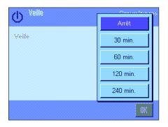
Vous pouvez désactiver la fonction économie d'énergie ("Arrêt") ou sélectionner une durée de 30,60,120 ou 240 minutes, après laquelle la balance doit passer dans le mode "Veille". Le mode "Veille" correspond à l'état dans lequel se situe la balance après arrêt à l'aide de la touche «**On/Off**». Pour rallumer la balance, pressez la touche «**On/Off**».
