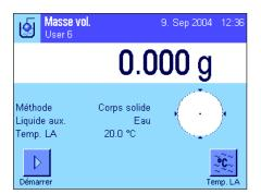
Dans les paramétrages spécifiques à l'application, sélectionnez la méthode **"Corps solide"** (chapitre 13.3.2) et déterminez le liquide auxiliaire voulu (chapitre 13.3.3).
