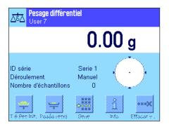
Après sélection de l'application apparaît l'écran ci-contre. D'origine, quelques touches de fonction spéciales ainsi que des champs d'information spéciaux pour le pesage différentiel sont activés. Vous pouvez adapter ceux-ci et d'autres paramétrages à vos besoins, conformément à la description dans les chapitres suivants.
