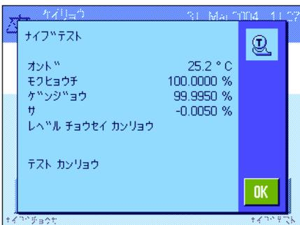
テスト過程が順調に完了すると左図のようなウィンドウが確認の意味で現れます。天びんにプリンターが接続されていると、このテスト過程は、システム設定において調整用に予め設定したプリセット内容に従って自動的にプリントアウトされます（第 6.3.7 項）。印字見本は第 8.4.6 項をご覧ください。
