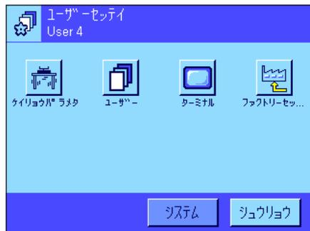
**ユーザー固有の設定を変更する：**《F5》キーを押して呼び出すことのできるこのメニューで、天びんをユーザーの作業テクニック及び作業課題に適合させることができます（第7章）。変更する設定内容はその時点で有効なユーザープロファイルに記憶され、このプロファイルのもとで使用される全てのアプリケーションに有効となります。従って、設定を変更する前に、望みのユーザープロファイルが選択されているかどうか確かめてください。
