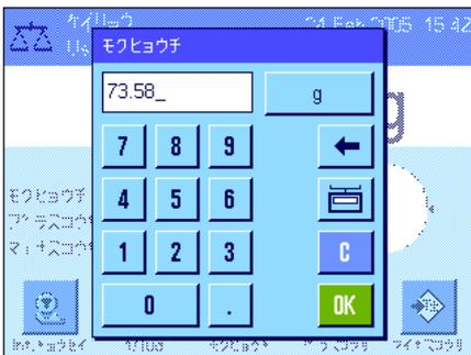
“モクヒョウチ” のファンクションキーを押します。希望する値を入力します。目標値の右に表示される計量単位を確認します。計量単位のボタンにタッチすると利用できる単位の種類が現れます。**備考：**計量単位の種類による自動換算はなされません。即ちある計量単位で入力した値は、計量単位を変更してもそのまま、変化しません。値を入力後、目標値としてアクティブにするには“OK”を押します。
