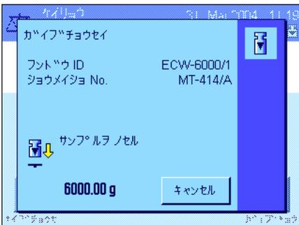
調整過程を開始させると、調整用分銅をのせるよう要求されます。所定分銅の ID 及び証明書番号が入力されていると、これも表示されます。所定分銅の質量はウインドウの下端に点滅して表示されます。
