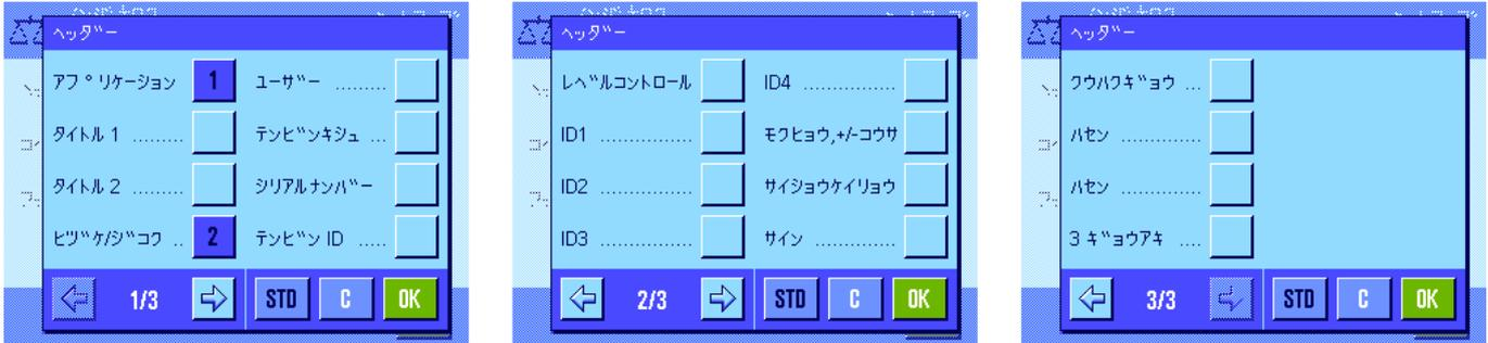
該当部分のボックスにタッチして望みの情報項目を選択します。チェックマークが付いた情報項目が印字されることになります。“STD”で工場設定に復帰し、“C”により、設定内容を記憶させずにメニュー操作を完了します。これとは逆に変更内容を記憶させる場合は“OK”にタッチします。
