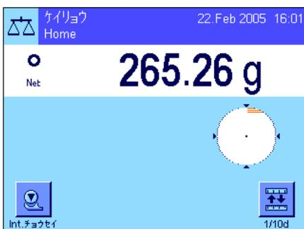
**計量：**被計量物をのせます。安定検知器（計量値の左の小リング）のアイコンが消えると、ディスプレイは安定し、計量値を読み取ることが出来ます。左図では安定検知器のアイコンが表示されたままで、計量結果はまだ安定していません。
