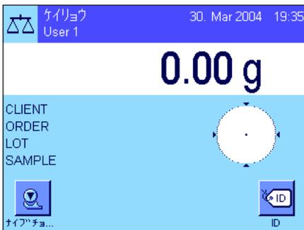
識別ラベルを使って作業する場合、該当情報項目（第 8.2.4 項）もオンにすることをお勧めします。情報項目には設定した 4 種類の識別ラベルの名称が表示されます。
