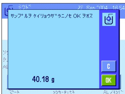
“スタート”ファンクションキーを押して、密度測定を開始します。シンカーをのせるよう指示がでます（大気中での計量）。
