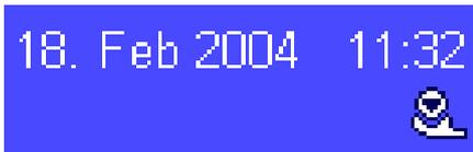
予め設定した時刻または温度判定規準が満たされると（第 6.3.2 項）、ディスプレイの右上コーナー、時刻表示の下に ProFACT の小さなアイコン（ステータス・アイコン）が現れます。天びんはこれにより、調整を実行する時であることをユーザーに通知します。**備考**：電源に接続後最初の 24 時間、ProFACT は予め設定した判定規準に関係なく、何回か調整を実行します。
