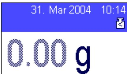
左図の例では、計量値の上に現れている小さな分銅のアイコン（ステイタス・アイコン）並びに計量値のグレー表示の数値は、現在まだ最小計量値には達しておらず、その時点での重量値は品質保証システムの規定公差範囲外であることを表しています。
