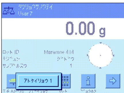
希望の後計量のスイッチボタンにタッチして、後計量を開始します。
