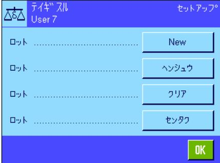
《昌》キーを押してロットを定義するメニューを選択します（メニューの第1ページ）。新しいロットを設定し、既存のロットを編集し、消去するためのオプションを利用できます。最後のメニューオプションで、作業の対象にしたいロットを選択することができます。これらのオプションについては以下の各項で説明します。
