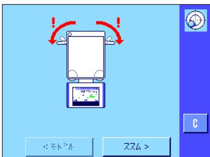
水平調整アシスタントは、先ずサポート脚用の固定レバーを外すよう指示します。
