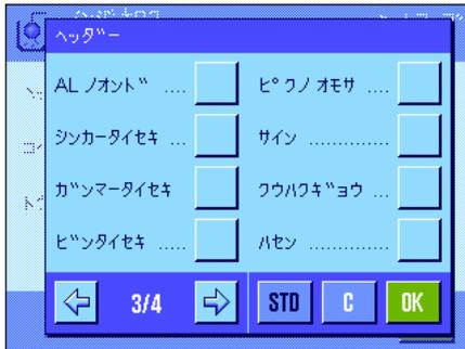
“ピクノオモサ” : 同名のファンクションキーで入力した比重びんの重量を印字記録します（比重びんを使用して液体の密度を測定する場合）。
