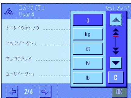
“ヒョウジタンイ” 及び “サンコウタンイ” のメニューでは既知の単位の他に “PCS” (個) の単位を利用できます (基準個数の重量が測定されていることが前提条件)。
