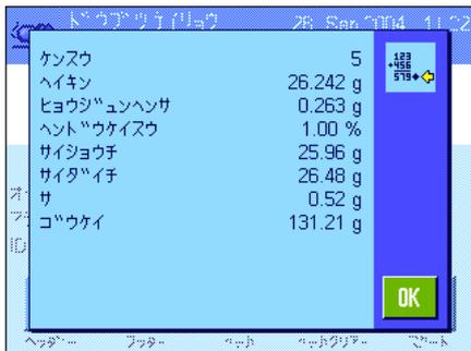
その時点での一連の計量作業を中断し、統計内容を消去して新規の計量シリーズを開始したい場合は、“ケッカクリアー”ファンクションキーを押します。統計が最終的に消去される前に、安全上の理由から、再確認するよう要求されます。**備考：**キーが薄く表示される場合は、統計に値が何も無いことを意味しています。
