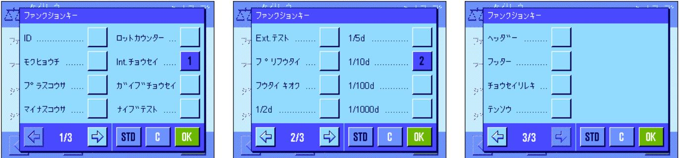
アプリケーションウィンドウで番号が付けられた機能が表示されます。この番号はディスプレイにおけるファンクションキーの表示順序を表します。該当ボタンにタッチしてスイッチをオンまたはオフにすると、キーの順序は自動的にアップデートされます。順序を完全に更新するには、先ず全てのファンクションキーの該当ボタンのスイッチをオフにして、望みの順序で該当ボタンのスイッチを再び入れます。“STD”にタッチすると工場出荷時の設定に復帰できます。“OK”にタッチして変更内容を記憶させます（記憶させずに入力ウィンドウを閉じる場合は“C”にタッチします）。
