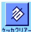
全ての成分の量り取りが完了すると、調合作業の結果を表示するウィンドウが自動的に現れ調合作業を終了し（あるいは中断する）、メモリーを次の調合のために消去したい場合は、“ケッカクリアー”ファンクションキーを押します（安全上の理由で、メモリー内容が実際に消去されるまえに、確認の画面が出ます）。**備考：**新たな調合作業は“ケッカクリアー”ファンクションキーを押した後で実行可能となります。
