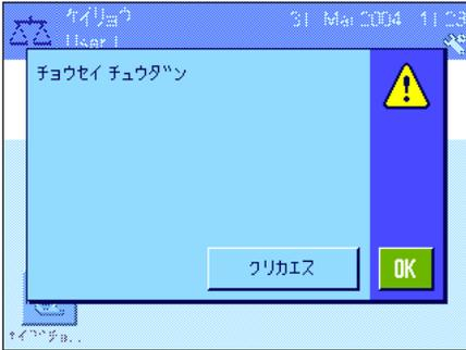
“**チョウセイ チュウダツン**”：ユーザー自ら調整過程を中断してもこのメッセージが表示されます。調整過程を再び開始するか、又は“**OK**”を押してアプリケーションに戻ることができます。
