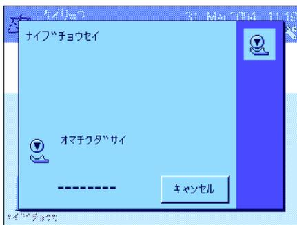
天びんから荷重が取り除かれ、ディスプレイが安定し、2 分間何もキー操作がなされない、調整（校正）過程が自動的に開始します。調整過程進行中、これをモニターできるウィンドウが現れます。アイコンはアニメ動作となり、調整過程をビジュアルに追跡することができます。調整実行が必要な時点で、丁度計量作業を実行している場合、ProFACT を“キャンセル”で中断できます。天びんは次の機会に全自動調整〔校正〕を開始します。
