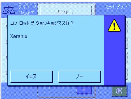
“ロット.....クリア” を選択します。消去したいロットを選択することのできるウィンドウが現れます。消去実行手順の前に、左図のような確認のウィンドウが現れます。イエスのボタンを押すと、全ての計量値および算出結果が消去されます。
