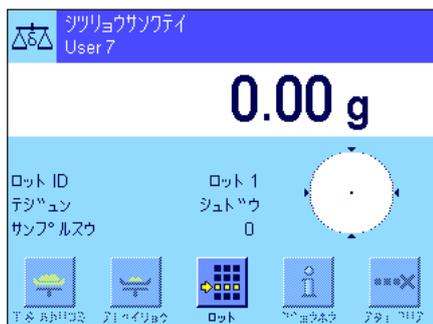
アプリケーションを選択すると左図のようなウィンドウが表示されます。工場出荷時に質量差測定の特別ファンクションキー及び情報項目がアクティブに設定されています。これも含めてさらに他の設定を、作業内容の必要に応じて以下の各項で述べてある方法で適応させることができます。
