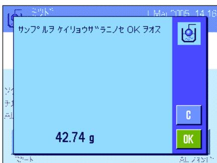
“**スタート**”ファンクションキーを押して、密度測定を開始します。天びんは自動的に風袋引きを実行し、続いて固体をのせるよう指示します（先ず大気中での計量）。
