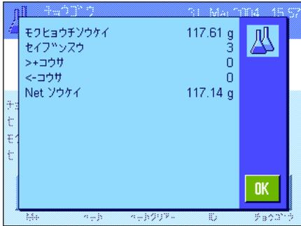
全ての成分の量り取りが完了したら、“ケッカ”ファンクションキーを押します（メモリーに値がある場合にだけ利用することができ、そうで無い場合キーはグレーに表示され、機能しません）。“ケッカ”ファンクションキーを押した後、調合作業の結果を表示するウインドウが現れます（結果の印字記録のために選択してある情報項目が表示されます。第 10.3.5 項をご覧ください）。
