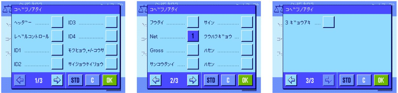
このサブメニューで、各個別の計量値の印字記録の情報項目を設定します。プリントは《⏏》キーを押すか又は自動的に実行されます（自動プリント機能がオンの場合、第 8.2.5 項参照）。
