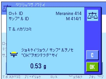
風袋の測定が終わると天びんは量り込みを実行するよう指示します。計量容器に被計量物を入れ、“OK”キーを押して初期計量を実行します。
