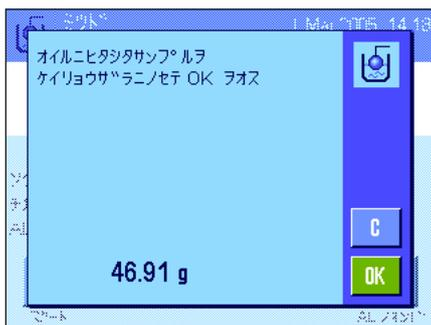
ここで固体を素早くオイルに浸し、再び天びんにのせるよう、指示が出ます（大気中での第2回目の計量）。
