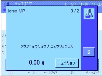
調合を呼び出すと、調合の定義において成分の量り取り用に設定した基本の種類によって（第 10.5.2 項）、先ず望みの**調合の最終重量又は第 1 成分の目標値**を入力するよう要求されます。
