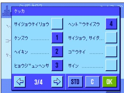
結果の印字記録は、表示されている統計ウィンドウで 《␣》 キーを押すとプリントアウトされます。一連の計量作業でサンプル数 (“サイダイケンスウ”) を設定してあると、最後のサンプルの計量値が 統計に算入されると自動的にプリントアウトされます。
