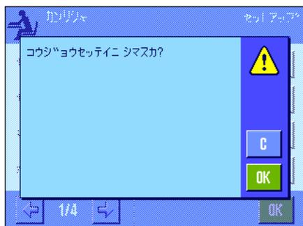
“マスターリセット” のメニューで天びんの全ての設定内容を工場設定に戻すことができます。“ジッコウスル” のスイッチエリアを押すと左図のような確認の質問が現れます。リセットを実行しない場合は “C” を押します。
