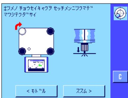
水平調整脚を天びん設置面に軽く触るまで回して引き下げます。
