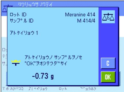
天びんが、後計量を実行するために選択したサンプルをのせるよう指示するまで待ちます。最初のサンプルが入った計量容器（風袋）を天びんにのせ、“OK”キーを押します。重量が測定されている間、これに該当するメッセージが現れます。
