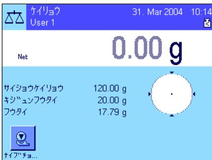
《→0←》キーを押して表示値をゼロに設定します。計量皿にフウタイ（計量容器）をのせ、《→T←》キーを押し、風袋引きを行います。天びんは風袋重量を計量し、“フウタイ”の情報項目欄に表示します。計量値の横に“Net”（正味重量）のアイコンが現れます。
