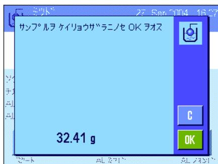
“スタート”ファンクションキーを押して、密度測定を開始します。天びんが自動風袋引きを実行した後、大気中で固体をのせるよう指示がでます。
