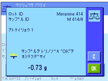
後計量が無事に完了すると、サンプルを取り除くよう指示が出ます。サンプルを容器と共に取り除き、“OK”キーを押して確認・承諾します。
