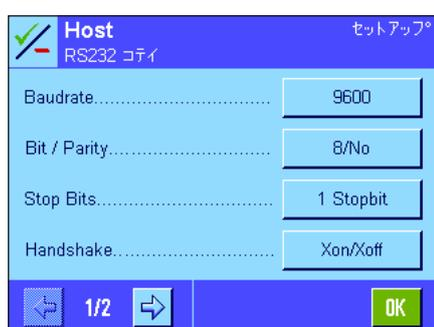
ある機器をオンにしたら“**テキスタイル**”ボタンでこの機器による相互コミュニケーション用の各種インターフェイス・パラメータであるボーレート、データフォーマット、ストップビット、ハンドシェイク、行端末、キャラクターセット、“コンティニュアスモード”（“ホスト”周辺機器用のみ）を設定することができます。
