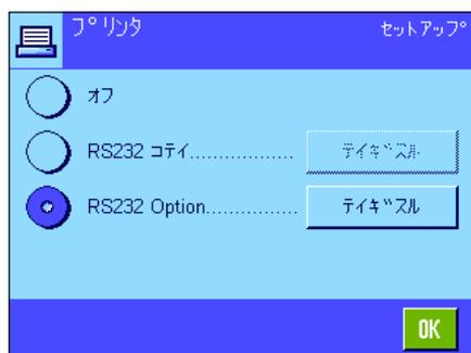
これらの各周辺機器に対しインターフェイス特有の設定を利用できます：“オフ”は何らの周辺機器も接続しないことを意味します。“RS232 fix”は標準搭載のRS232Cインターフェイスです。さらに別のオプションインターフェイスがある場合は、これも表示されます（左図が示すように第2のシリアル・インターフェイス“RS232 Option”）。但し、この箇所には工場内蔵のRS232Cインターフェイスのパラメータだけが表示されます。**重要事項：**各インターフェイスでは周辺機器1台のみを動作させることができます。その他の機器のスイッチは切れている（“オフ”）状態である必要があります。新しい機器のスイッチを入れると、それまで選択していた機器は自動的にそのスイッチが切れます。
