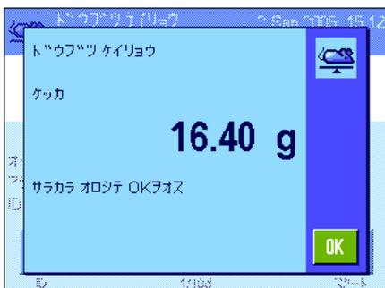
計量が完了すると、結果が表示され、同時に計量物を天びんから取り除くよう要求されます。
