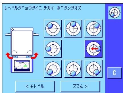
天びんの水準器 (これはバックライト付きで、内蔵レベルコントロール・センサーと連動します) を観察し、その時点での水準器の気泡の位置に該当するスイッチボタンを押します。水平調整アシスタントは、両方の水平調整脚 (上のイラストの“B”の位置) の回転方向を赤い矢印で示します。
