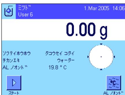
アプリケーション特有の設定において、密度測定方法として“**タコウセイコタイ**”を選択し（第 13.3.2 項）、さらに希望の置換液を選択します（第 13.3.3 項）。
