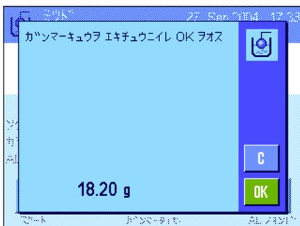
サンプルの風袋引きを実行すると、ガンマー球をサンプル物質に浸すよう指示が出ます。ガンマー球によって押しつけられたサンプルの重量がウインドウの左下のコーナーに表示されます。
