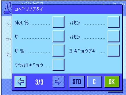
“サ %” : その時点での成分の実際重量と目標重量との差を目標値に対する割合として印字記録します。
