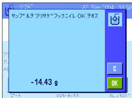
風袋引きを実行すると、その密度測定の対象である液体を容器に入れるよう指示が出ます。オプションの密度測定キットを使用する場合は、これに付属している説明書を参考にして下さい。床下計量フックを利用する場合は、液体の入った容器をこの下に置きます。いずれの場合も、シンカーが少なくとも 1 cm 液中に浸り、容器の液体中に気泡が一切無いことを確認して下さい。
