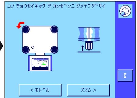
水平調整脚を赤の矢印方向へ回して上へ一杯に上げます。
