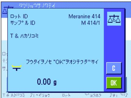
天びんが最初のサンプルの計量容器（風袋）を天びんにのせるよう指示するまで少々待ちます。容器をのせたら、“**OK**”キーを押します。風袋測定が実行される間、これに該当するメッセージが現れます。
