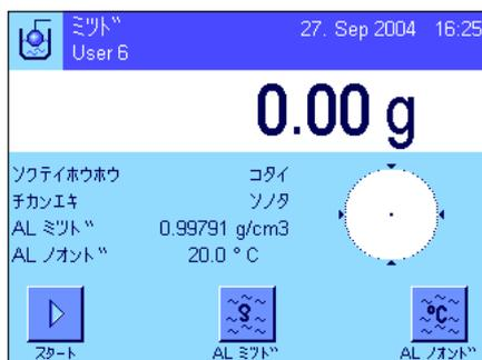
蒸留水またはエタノール以外の別の置換液を使用する場合は、“AL ミツド”ファンクションキーをオンにしてから、このキーにより、その時点の温度における使用置換液の密度を入力します（g/cm3 単位、小数点以下最高 5 桁）。天びんには蒸留水またはエタノール以外の置換液の密度表が予めメモリーされていないため、この手順が必要です。この入力値は予め設定してある同名の情報項目に現れます。
