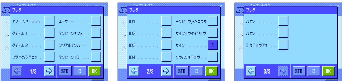
このサブメニューでは、計量値（個別の値）の印字記録のフッターとしてプリントアウトする内容を設定します。“フッター” のファンクションキーを押すとフッターがプリントアウトされます。
