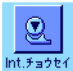
このファンクションキーを押して、内蔵分銅を用いて天びんを調整（校正）します。都合の良い時にいつでも実行できます。
