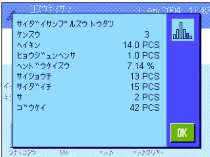
結果ウィンドウは一連の結果を示します（結果の情報項目用に選択した情報データが表示されます。第 11.3.7 項をご覧ください）。表示値の単位、分解能、精度に関して第 11.4.5 項にのべてある事柄にご注意下さい。
