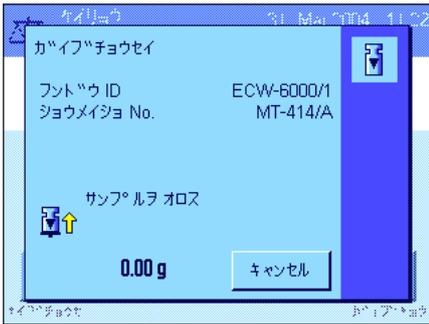
要求された分銅をのせると、調整過程は自動的に開始されます。調整過程が完了すると、分銅を取り除くよう、要求されます。計量皿から分銅を取り除いてください。
