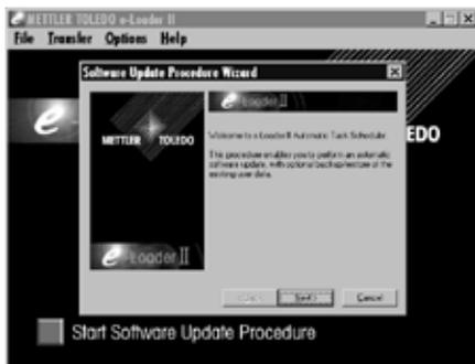
必要な設定を行い、接続状態のチェックを済ませると、アップデートを開始できます。“Start Software Update Procedure” をクリックします。アップデート過程を一步步進めて行くために、e-Loader II が出す指示に従ってください。その時点における天びんの設定をバックアップとしてコンピュータに保存したいかどうか、e-Loader II が質問します。このバックアップ手順を実行することをお勧めします。アップデートにより天びんの設定は全て工場出荷時の設定にリセットされるため、ユーザー各自の設定を再度実行する手間が省けます。e-Loader II のアップデート過程の最後に、バックアップしてある設定内容のデータを再び天びんにインストールするかどうかの質問が出ます。
