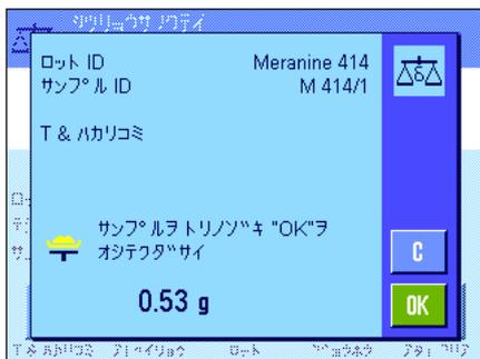
量り込みが完了すると、サンプルを取り除くよう指示が出ます。サンプルの入った容器を取り除き、“OK”キーを押して確認・承諾します。
