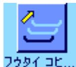
“**フウタイコピー**”ファンクションキーにより、最初のサンプルの風袋値を、ロットの後続サンプルの内まだ風袋が測定されていない全てのサンプルに対して適用することができます（既存の風袋値は記憶されています）。この機能により、全てのサンプルに同一の風袋容器を使用する場合、時間を大幅に節約することができます。
