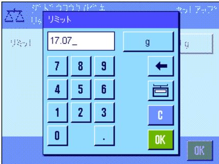
“ジドウフウタイビキ” ファンクションキーにスイッチを入れると（“オン”）、“**テイギスル**”のスイッチボタンで自動風袋引き機能のための重量判定基準を設定できます：
