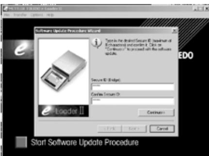
“Secure ID” を定義し、所定の “Confirm Secure ID” の欄に再度入力して確認・承諾します。続いて “Continue” をクリックします。
