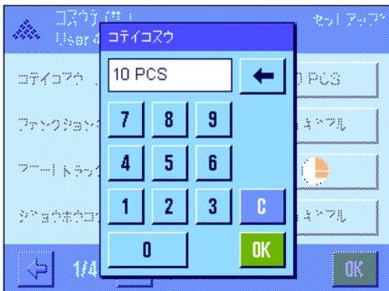
このメニューで“コテイコスウ” ファンクションキー（第 11.3.3 項）が照合する固定基準個数を確定します。該当ボタンを押すと入力ウィンドウが現れ、固定基準個数を定義することができます。
