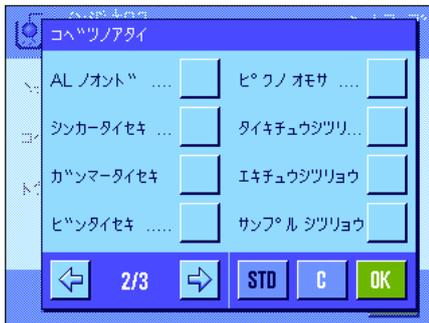
“シンカータイセキ” : 同名のファンクションキーで入力 設定したシンカーの体積（液体の密度をシンカーを用いて測定）。
