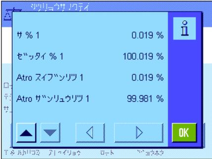
ある1つのサンプルの結果が複数のウィンドウにわたる場合は、ウィンドウの左下のスクロール・ボタンでウィンドウ表示を切り換えることができます。
