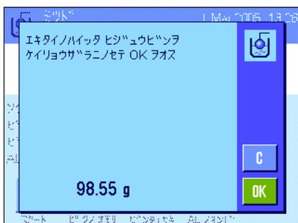
“スタート”ファンクションキーを押して密度測定を開始します。続いて液体で満たされた比重びんをのせるよう指示が出ます(該当比重びんの重量が負の値としてディスプレイの左下コーナーに表示されます)。
