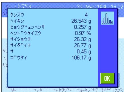
統計結果ウィンドウは一連の計量過程の結果を表示します（結果の印字記録用に予め設定した情報項目が表示されます。第 9.3.5 項をご覧ください）。また第 9.4.3 項の計量単位、分解能、及び表示値の精度に関する説明にもご注意ください。
