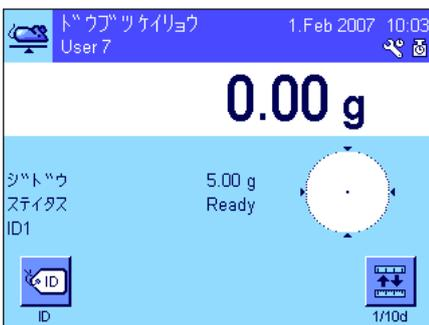
アプリケーションを選択するとディスプレイには左図のように表示されます。動物計量特有の数種類の情報項目が工場設定としてアクティブになっています。この設定を含めて、その他の設定を各ユーザーのニーズに対応させる方法を以下に述べてあります。
