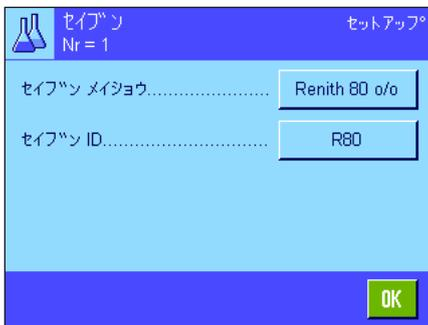
各成分は**名称及び識別ラベル (ID)**から成っています。該当ボタンにタッチして、名称及び識別データ（最高20文字）を設定することができる英数字、カタカナの入力エリアを開きます。ソフトウェアは入力内容のブラウシビリティをチェックします：別の成分に使用した名称または ID を入力しようとする、エラーメッセージが出ます。**備考**：該当製品の成分と確実に照合することができるよう、実際の現場ではバーコードリーダでIDを読み取る場合が頻繁にあります。名称として該当製品の通称を使用することができます。左図の例では第1番の成分には名称とIDが既に設定されています。
