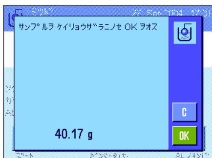
“スタート”ファンクションキーを押して密度測定を開始します。間もなくサンプルをのせるよう（ガンマー球無し）指示がでます。
