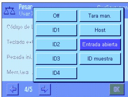
**"ID muestra":** El código de barras leído se interpreta como identificación de la muestra. Si la serie actual contiene una muestra con esta ID, la abrirá y la pondrá directamente a su disposición para la elaboración de la siguiente etapa de trabajo. Si la ID de muestra no existe en la serie actual, aparecerá un mensaje informándole de ello.
