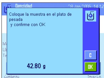
Pulse la tecla de función "Comienzo" para empezar la determinación de la densidad. La balanza llevará a cabo un tarado automático; a continuación, se le pedirá que deposite el sólido (primera pesada en el aire).
