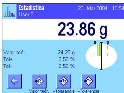
Cuando haya introducido el valor teórico y las tolerancias, aparecerá en la pantalla la guía gráfica para dosificaciones ("SmartTrac"), con límites de tolerancia que le facilitarán las pesadas con valor teórico: Puede realizar una dosificación aproximada de sus muestras hasta alcanzar el valor de tolerancia inferior y, en caso necesario, realizar después una dosificación fina hasta llegar al valor teórico.
