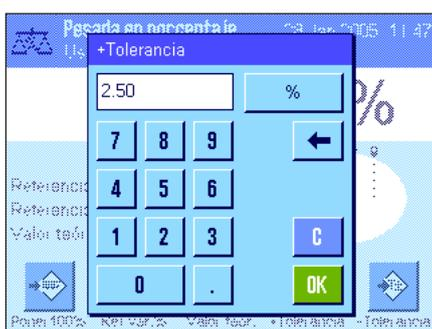
Cuando haya introducido el valor teórico y las tolerancias, aparecerán en la pantalla los límites de tolerancia para la guía gráfica para dosificaciones ("SmartTrac"). Los límites de tolerancia le facilitarán las pesadas con valor teórico: Puede realizar una dosificación aproximada de sus muestras hasta alcanzar el valor de tolerancia inferior y, en caso necesario, realizar después una dosificación fina hasta llegar al valor teórico.
