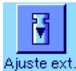
Pulsando esta tecla de función ejecutará un ajuste de la balanza con una pesa de calibración externa. Puede hacerlo en cualquier momento, pero también es posible determinar en la configuración del sistema que la balanza le solicite un ajuste determinados días de la semana y a horas determinadas (capítulo 6.3.3). **Advertencia:** Dependiendo de la normativa nacional, en ocasiones el ajuste con una pesa externa no es posible en balanzas verificadas.
