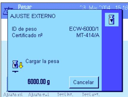
Tras iniciar el proceso de ajuste, se le pide que coloque la pesa de calibración. Si está disponible, se muestra la ID y el número de certificado de la pesa correspondiente. En la parte inferior de la pantalla parpadea el valor ponderal necesario.
