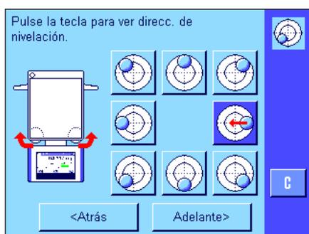
Observe la burbuja de nivel de su balanza (ésta se ilumina si el sensor de inclinación está conectado) y pulse el botón cuya imagen se corresponda con la posición actual de la burbuja de aire en la burbuja de nivel. El asistente de nivelación le muestra mediante flechas rojas la dirección en la que se deben girar los dos patas nivelantes (posición [B] en la ilustración superior).
