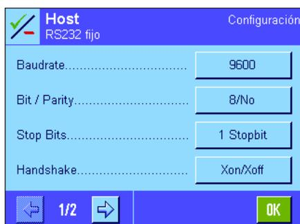
Si ha activado un equipo, al pulsar el botón "Definir", podrá establecer los parámetros de interface para la comunicación con dicho equipo, es decir, velocidad en baudios, formato de datos, bits de parada, Handshake, carácter de fin de línea, juego de caracteres y "modo continuo" (solo para el equipo periférico "Host").
