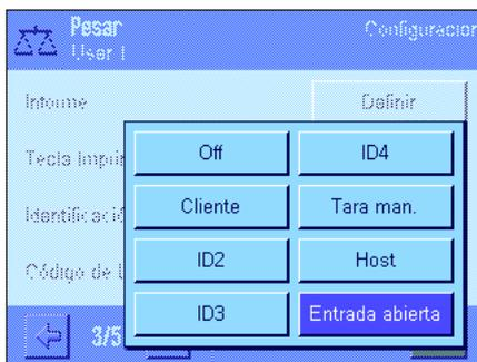
**"Off":** No se procesan datos de códigos de barras. Debe utilizar este ajuste si no hay ningún lector de códigos de barras conectado.
