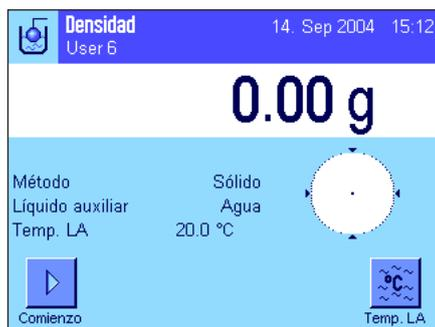
Una vez seleccionada la aplicación, aparece la pantalla contigua. De fábrica, vienen activados campos Info y teclas de función especiales de la determinación de la densidad. La balanza está preconfigurada para la determinación de densidades de sólidos utilizando agua como líquido auxiliar. Puede adaptar esta configuración a sus necesidades, según se explica en los siguientes Capítulos.
