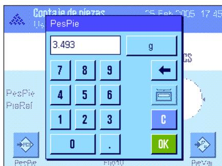
**Si se conoce el peso unitario**, se puede introducir directamente. Para ello, pulse la tecla de función "Pes. Pie.". Aparecerá un campo de entrada de datos en el que se puede introducir el peso unitario en la unidad deseada.
