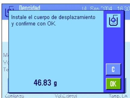
Pulse la tecla de función **"Comienzo"** para empezar la determinación de la densidad. Se le pedirá que instale el cuerpo de desplazamiento (pesada en el aire para tarado).
