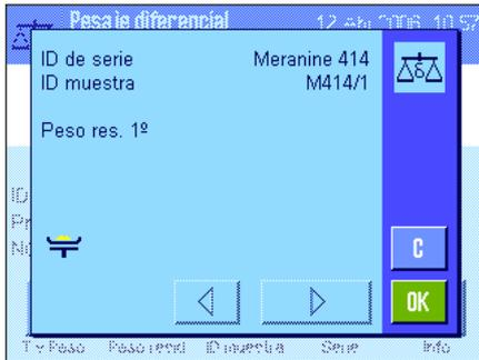
La balanza muestra la primera muestra de la serie para la que todavía no existe ninguna pesada diferencial. Si usted desea pesar otra muestra, pulse las teclas de flecha en la parte inferior de la ventana para desplazarse hasta ella. En este ejemplo, suponemos que desea comenzar con la primera muestra. Confirme su elección con la tecla "OK".
