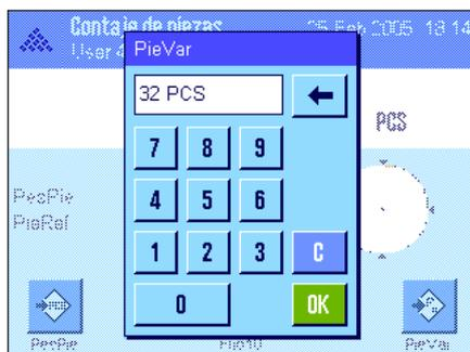
Si ha colocado un **número de piezas de referencia diferente** (que no corresponde a la tecla de función "Pie. Fij.", p. ej., 32 piezas), pulse la tecla de función "Pie. Var." (contaje variable). Aparecerá un campo de entrada de datos en el que puede introducir el número de piezas.
