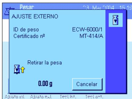
Una vez depositado el peso necesario, el proceso de ajuste se iniciará automáticamente. Al final del proceso de ajuste se le pedirá que retire la pesa. Quite la pesa de calibración del plato de pesada.
