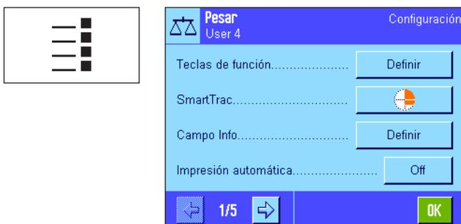
**Modificación de la configuración específica de la aplicación:** Si quiere modificar la configuración de la aplicación activa, pulse la tecla «[Menu Icon]». Los ajustes que aquí realice se guardarán en el perfil del usuario activo; por ello, antes de realizar ajustes, asegúrese de que esté activo el perfil de usuario deseado. Encontrará información sobre la configuración específica de la aplicación en la descripción que se hace de cada una de ellas (capítulo 8 y siguientes).
