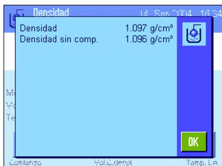
La balanza calculará ahora la densidad del líquido y mostrará el resultado a continuación (valor compensado y/o no compensado, de acuerdo con la configuración que haya realizado para la emisión del resultado; véase capítulo 13.3.5).
