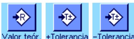
Si quiere realizar una **formulación libre** sin utilizar fórmulas de la base de datos, deberá activar además las teclas de función "Valor teór.", "+Tolerancia" y "-Tolerancia". Con estas teclas se pueden introducir los correspondientes valores.
