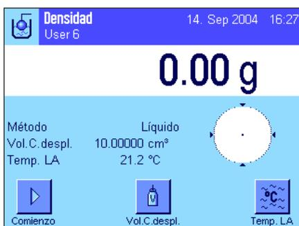
Seleccione el método **"Líquido"** en la configuración específica de la aplicación (capítulo 13.3.2).
