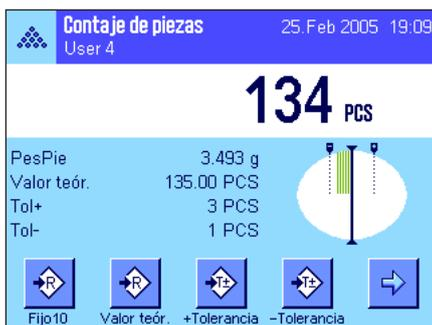
Cuando haya introducido el valor teórico y las tolerancias aparecerá en la pantalla la guía gráfica para dosificaciones ("SmartTrac"), con límites de tolerancia que le facilitarán las pesadas con un valor teórico: Puede realizar una dosificación aproximada de sus muestras hasta alcanzar el valor de tolerancia inferior y, en caso necesario, realizar después una dosificación fina hasta llegar al valor teórico.
