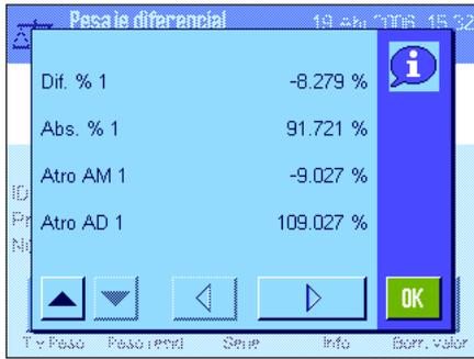
En caso de que los resultados de una muestra abarquen varias ventanas, podrá cambiar de unos a otros con las teclas de desplazamiento de la esquina inferior izquierda de la pantalla.
