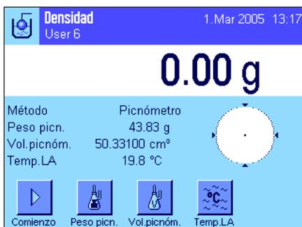
Seleccione el método **"Picnómetro"** en la configuración específica de la aplicación (capítulo 13.3.2).
