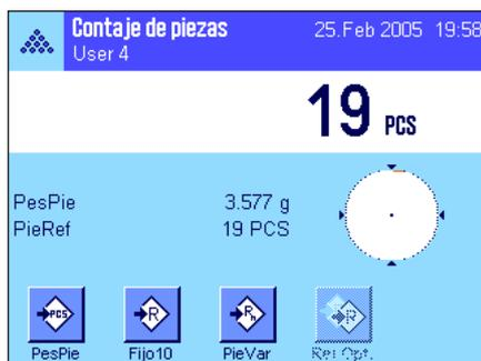
Continúe con el contaje de piezas y coloque más piezas. Para optimizar la referencia, pulse la tecla de función "Ref.Opt.". El contaje existente se utilizará como nuevo contaje de referencia, y se calculará de nuevo el peso unitario de referencia sobre esta base.
