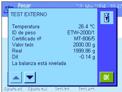
Tras finalizar satisfactoriamente la comprobación aparece esta ventana. Si hay una impresora conectada a la balanza, el informe de la comprobación se imprime automáticamente según las especificaciones que haya escogido en la configuración del sistema para los informes (capítulo 6.3.7). Encontrará un modelo de informe en el capítulo 8.4.6.
