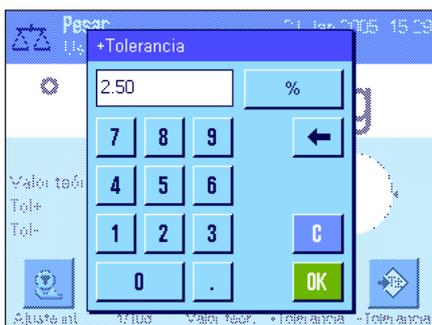
Con las dos teclas de función "**+Tolerancia**" y "**-Tolerancia**" puede definir la precisión con la que desea pesar. La ventana de entrada de datos es idéntica a la del valor teórico. De fábrica, ambos valores de tolerancia vienen fijados en 2,5%. En lugar de un valor porcentual, se puede introducir una tolerancia absoluta en cualquier unidad (p. ej., "g"). Tras introducir el valor, pulse "**OK**" para activar las tolerancias.
