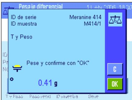
Tras el cálculo de la tara, se le pedirá que lleve a cabo la pesada inicial. Coloque la sustancia que desea pesar en el recipiente de pesada y pulse la tecla "OK" para realizar la pesada inicial.
