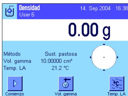
Seleccione el método "Sust. pastosa" en la configuración específica de la aplicación (capítulo 13.3.2).
