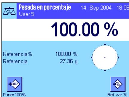
Si, por el contrario, desea asignar al peso colocado una **referencia variable**, pulse la tecla de función "Ref.var.%". Aparecerá un campo de entrada en el que puede determinar el valor porcentual (p. ej., 60%) al que debe corresponder el peso colocado.
