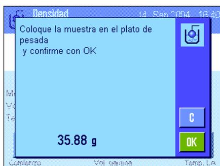
Pulse la tecla de función "Comienzo" para empezar la determinación de la densidad. A continuación, se le pedirá que deposite la muestra (sin esfera gamma).
