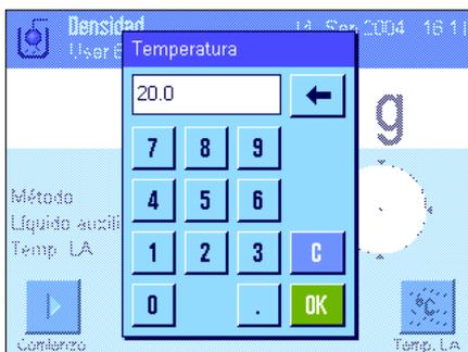
Si utiliza **agua o etanol como líquido auxiliar**, introduzca su **temperatura** con la tecla de función "**Temp. LA**" (en la balanza hay guardadas tablas de densidades para estos dos líquidos en el intervalo de temperatura de 10 °C a 30 °C; consulte también los capítulos 13.7 y 13.8). La ilustración de la izquierda muestra el campo de entrada correspondiente (entrada en °C con un decimal).
