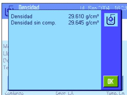
La balanza calculará ahora la densidad del sólido y mostrará el resultado a continuación (valor compensado y/o no compensado, de acuerdo con la configuración que haya realizado para la indicación del resultado; véase capítulo 13.3.5).
