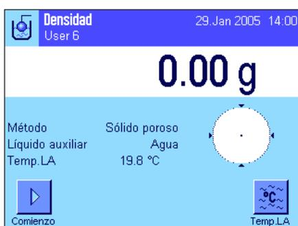
Seleccione el método "Sólido poroso" en la configuración específica de la aplicación (capítulo 13.3.2) y determine el líquido auxiliar que desee utilizar (capítulo 13.3.3).
