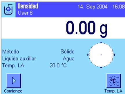
Seleccione el método "**Sólido**" en la configuración específica de la aplicación (capítulo 13.3.2) y determine el líquido auxiliar que desee utilizar (capítulo 13.3.3).
