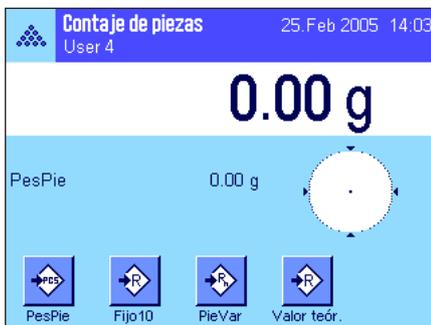
Una vez seleccionada la aplicación aparece la pantalla contigua. De fábrica, vienen activados un campo Info y las teclas de función especiales para el contaje de piezas. Puede adaptar la configuración a sus necesidades según se explica en los siguientes Capítulos.
