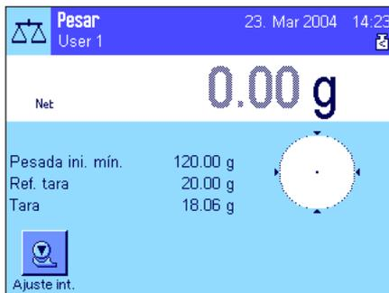
Pulse la tecla «→0←» para poner a cero el indicador. Coloque la tara (recipiente de pesada) sobre el plato de pesada y pulse la tecla «→T←» para tarar la balanza. La balanza calcula el valor de tara y lo muestra en el campo Info "Tara". Junto al indicador de peso aparece el icono "Neto" (peso neto).
