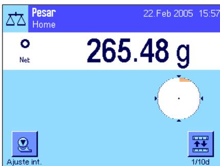
**Pesar:** Deposite el objeto que desea pesar. En cuanto se apague el símbolo de control de estabilidad (el anillo pequeño a la izquierda de la indicación del peso), la pantalla estará estable y podrá leer el resultado de pesada. En la ilustración de la izquierda, el símbolo del control de estabilidad continúa en pantalla y, en consecuencia, el resultado de pesada todavía no es estable.
