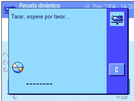
En cuanto retire la muestra, la pantalla volverá al cero automáticamente (suponiendo que la función "Tara automática" esté activada) y la balanza quedará lista para la siguiente pesada.
