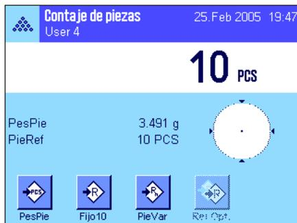
Calcule la referencia con el método deseado (contaje de referencia fijo o variable, véase capítulo 11.4.1). En el ejemplo de la izquierda se utilizó un contaje de referencia de 10.
