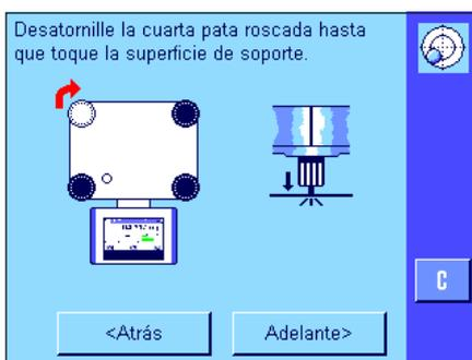
Gire la pata regulable hacia abajo hasta que quede "ligeramente" apoyada sobre la base.
