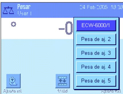
Tras pulsar la tecla de función "Ajuste. ext.", aparecerá una lista en la que podrá seleccionar la pesa de calibración. **Advertencia:** En la ilustración de la izquierda, todas las pesas de calibración siguen llevando la denominación de fábrica excepto la primera, a la que se le ha asignado su propia designación (capítulo 6.3.4). El ajuste comenzará inmediatamente después de la selección de la pesa.
