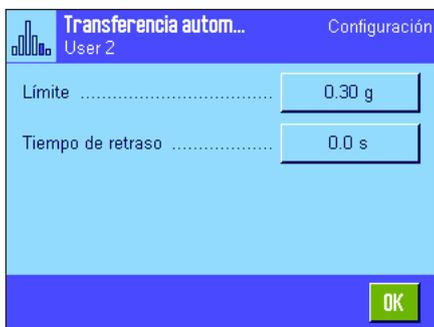
Si activa esta función ("On"), puede determinar los criterios de la transferencia automática del peso mediante el botón "Definir":
