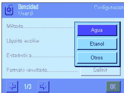
**"Agua":** En la balanza están guardadas las densidades del agua destilada a las temperaturas de 10.0 °C a 30.0 °C.
