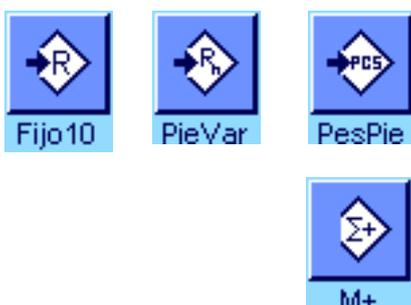
Realice el primer contaje de piezas y pulse la tecla de función "M+", para transferir el resultado a la estadística. Cuando el resultado se estabilice (los guiones horizontales de la pantalla desaparecen), éste se transferirá a la estadística. El encabezamiento del informe se imprime junto con el resultado (valor individual) del contaje de piezas actual (capítulo 11.3.7).
