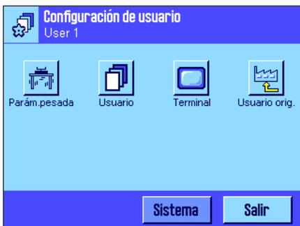
“**Parám. pesada**”: Configuración para adaptar la balanza a determinadas tareas de pesada (capítulo 7.3).
