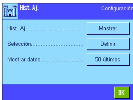
La balanza registra en principio todos los procesos de ajuste realizados y los guarda protegidos contra los fallos de la red. En este menú puede ver una lista de estos procesos, y determinar qué tipo de procesos de ajuste debe incluir y cuál debe ser el tamaño de la lista.
