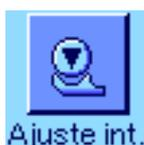
Pulsando esta tecla de función ejecutará un ajuste de la balanza con la pesa de calibración incorporada. Puede hacerlo en cualquier momento.
