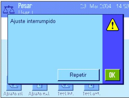
**Se produjo un error durante el ajuste y se ha interrumpido el proceso.** Este mensaje aparece también cuando es el propio usuario quien cancela el ajuste. Puede repetir el proceso o volver a la aplicación pulsando "OK".
