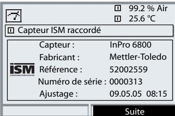
Tous les paramètres propres au capteur sont automatiquement transmis à l'appareil de mesure. Cela concerne par exemple la plage de mesure, le zéro et la pente du capteur, mais aussi le type de sonde de température. La mesure s'effectue immédiatement sans autre forme de programmation, la température mesurée est enregistrée simultanément.
