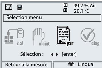
La programmation d'un capteur ISM est beaucoup plus simple et plus sûre que celle de capteurs conventionnels. Comme les capteurs ISM sont accompagnés d'une "fiche de données électronique", de nombreux paramètres sont déjà transmis par le capteur lui-même et repris automatiquement par l'appareil de mesure.
