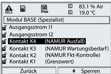
**NAMUR-Signale;** Lieferzustand der Kontaktbelegung
