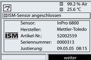
Automatisch werden alle sensortypischen Parameter an das Meßgerät übermittelt. Das betrifft zum Beispiel Meßbereich, Nullpunkt und Steilheit des Sensors, aber auch den Temperaturfühlertyp. Ohne jede weitere Parametrierung wird sofort gemessen, die Meßtemperatur wird simultan erfaßt.
