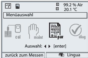
Die Parametrierung eines ISM-Sensors ist erheblich einfacher und sicherer als die konventioneller Sensoren. Da ISM-Sensoren ein "elektronisches Datenblatt" mit sich führen, werden viele Parameter bereits vom Sensor geliefert und automatisch vom Meßgerät übernommen.
