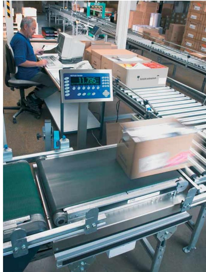
timent nach Maß: Von Industrie-Präzisionswaagen mit 3,2 Mio. Punkten interner Auflösung bis zu kostengünstigen DMS/Analogwaagen, vom Milligramm bis zu Tonnen. Im Verbund mit dem Terminal IND690 mit der Software IND690control optimieren Sie den Warenfluss auch in Ihrer Produktion.
