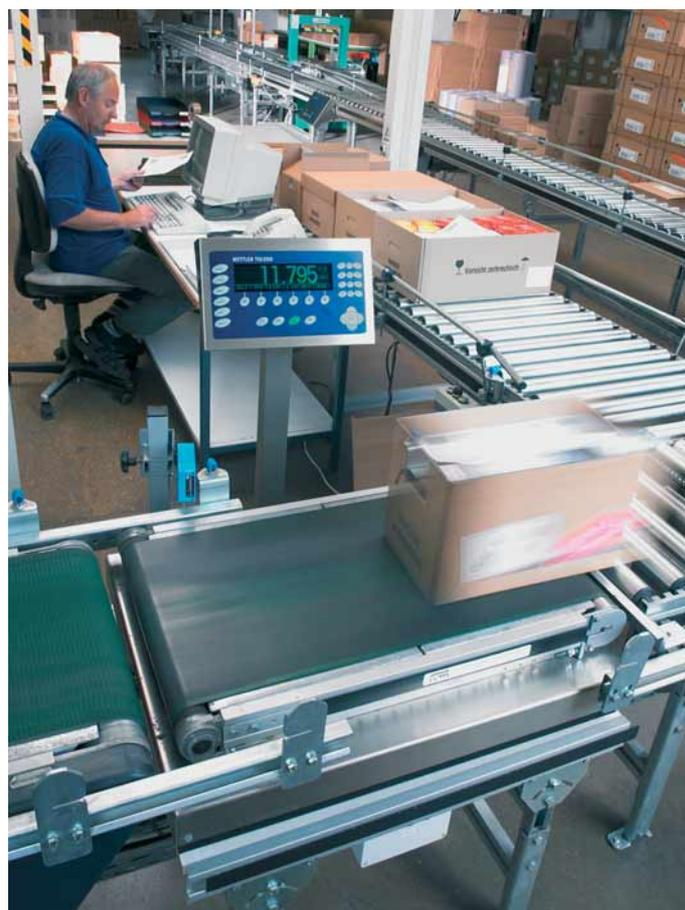
s'étendant des balances de précision industrielles dotées d'une résolution interne de 3,2 millions de points jusqu'aux balances analogiques à jauges de contrainte d'un coût peu élevé, du milligramme jusqu'à plusieurs tonnes. Interconnectées au terminal IND690 doté du logiciel IND690control, elles optimisent également les flux de marchandises de votre production.
