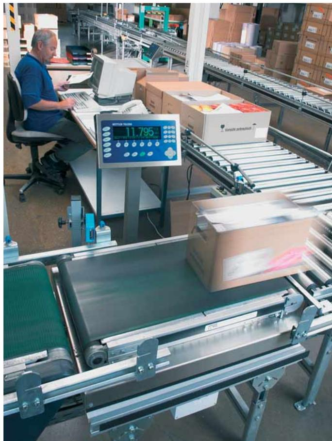
dai basamenti ad alta precisione con 3,2 milioni di punti di risoluzione interna fino a basamenti con celle di carico analogiche DMS. La precisione è di casa in METTLER TOLEDO: dal milligrammo alle tonnellate. Il terminale IND690 con il software d'applicazione IND690control vi permette di ottimizzare il flusso logistico della produzione.
