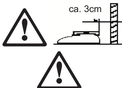
Si le **câble d'alimentation** est endommagé, il convient de ne plus utiliser la balance. C'est la raison pour laquelle, il convient de vérifier régulièrement l'état du câble et de veiller à laisser un espace libre d'environ 3 cm à l'arrière de la balance, afin que celui-ci ne soit pas plié de manière excessive.
