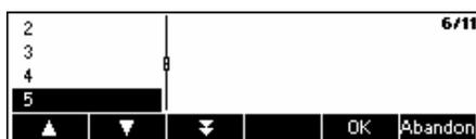
Sélectionner le niveau de contraste en faisant défiler les touches «**▼**» ou «**▲**». Appuyer sur la touche «**OK**» pour confirmer la sélection.
