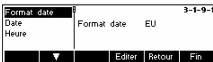
Appuyer sur la touche « **Editer** » pour régler le format sur US ou EU. Sélectionner Date pour changer la date et Heure pour modifier l'heure de la balance. Appuyer sur la touche « **OK** » pour confirmer la sélection.
