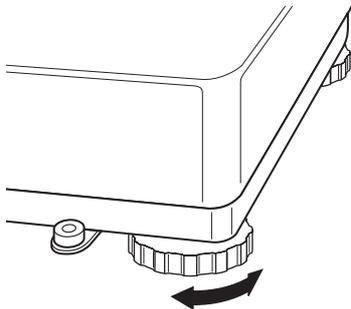
Tourner le pied réglable de manière à ce que la balance soit horizontale. Si un niveau à bulle est présent, la bulle doit toujours se trouver à l'intérieur du cercle.
