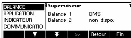
Accéder au menu BALANCE (« >>> »), sélectionner la balance appropriée (balance 1 ou 2; noter que ce sous menu apparaît uniquement si une seconde balance est installée avec l'option analogique) et choisir l'une des fonctions listées ci-dessous.
