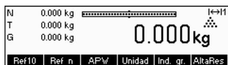
Al poner en marcha la balanza se inicia un test del display en el que aparecen brevemente todos los segmentos y la versión del software. Una vez aparece el punto decimal en la pantalla, la balanza está lista para funcionar.
