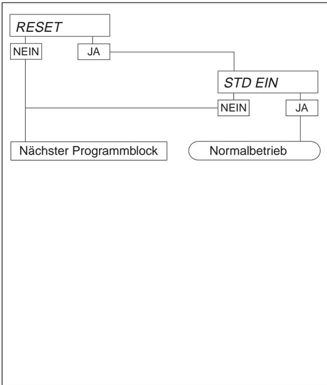
Der Programmblock RESET ermöglicht Ihnen, im Mastermode einmal veränderte Parameter mit einem Tastendruck auf Standard- bzw. Werkseinstellung zurückzubringen. Für Standardeinstellung quittieren Sie STD EIN mit JA.
