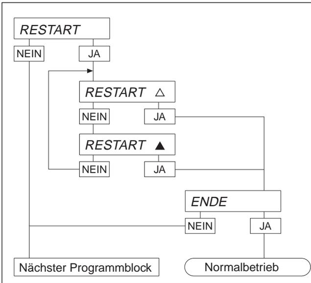
Wenn die Restart-Funktion aktiviert ist, bleiben nach Ausschalten des Terminals Nullpunkt und Tarawert gespeichert. Nach Einschalten zeigt die Waage in diesem Fall nicht Null, sondern das aktuelle Gewicht an.
