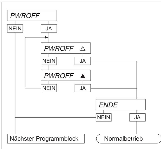
Wenn die automatische Abschaltung aktiviert ist, schaltet sich die Waage automatisch aus, wenn während mehr als 10 min kein Gewicht aufgelegt wird.
