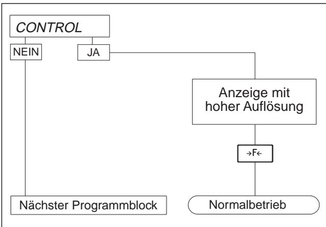
Im Programmblock CONTROL können Sie für Testzwecke die Auflösung der Anzeige erhöhen.
