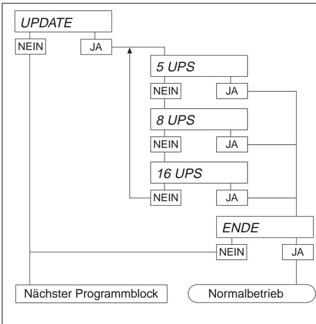
Die Anzeigegeschwindigkeit kann über die Anzahl der Meßwerte pro Sekunde (Updates pro Sekunde, UPS) stufenweise eingestellt werden.
