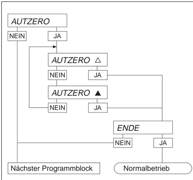
Bei unbelasteter Wägebrücke wird durch die automatische Nullpunktkorrektur das Gewicht leichter Verschmutzungen automatisch korrigiert. Je nachdem, ob Sie diese Korrektur wünschen, besteht in diesem Block die Möglichkeit, die automatische Nullpunktkorrektur ein- bzw. auszuschalten.
