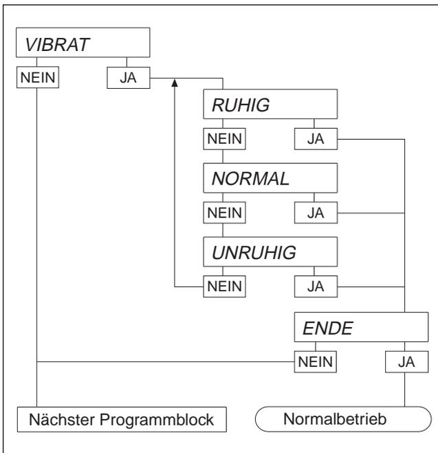
Je nach Einsatzort kann die Waage mehr oder weniger starken Vibrationen ausgesetzt sein, die sich nicht verhindern lassen. Falls dies der Fall ist, bietet der Programmblock VIBRAT die Möglichkeit, die Waage an die vorhandenen Vibrationen anzupassen.
