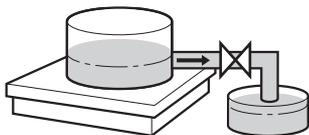
En la salida de dosificación se dosifica al recipiente de envase de un depósito de reserva en la plataforma de pesada.
