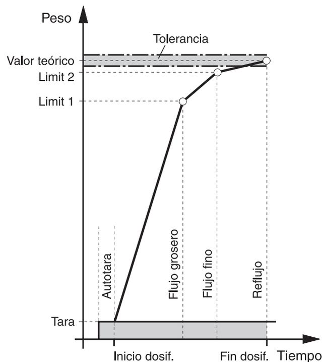
Si no se ha introducido ningún Limit, el ID7-Dos determina automáticamente Limit 1 y Limit 2 en un modo aprendizaje, ver página 21. El valor teórico se obtiene luego exactamente en la primera dosificación.
