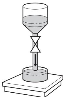
En la entrada de dosificación se dosifica de un depósito de reserva al recipiente de envase en la plataforma de pesada.
