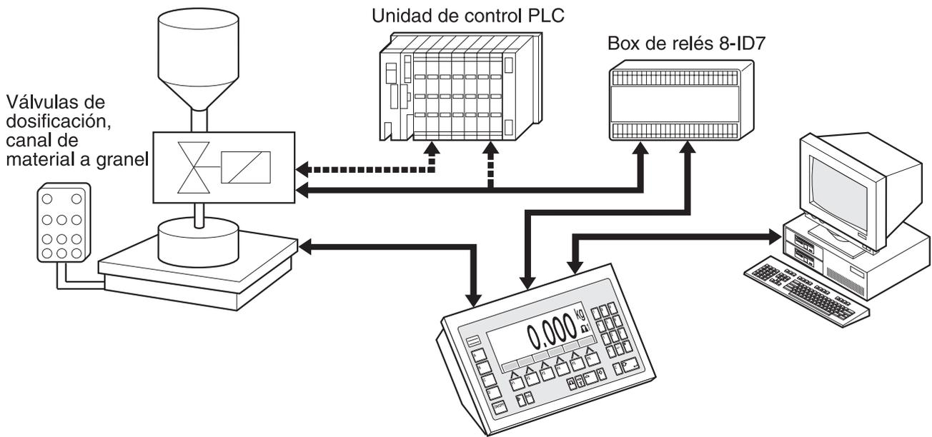
Las señales de mando para las válvulas dosificadoras se transmiten a la box de relés 8-ID7, a través del interface RS485-ID7. La box de relés 8-ID7 controla la instalación dosificadora, directamente, o a través de una unidad adicional externa (PLC). Si en la plataforma de pesada hay carga de más o carga de menos, se cierran inmediatamente todas las válvulas.
