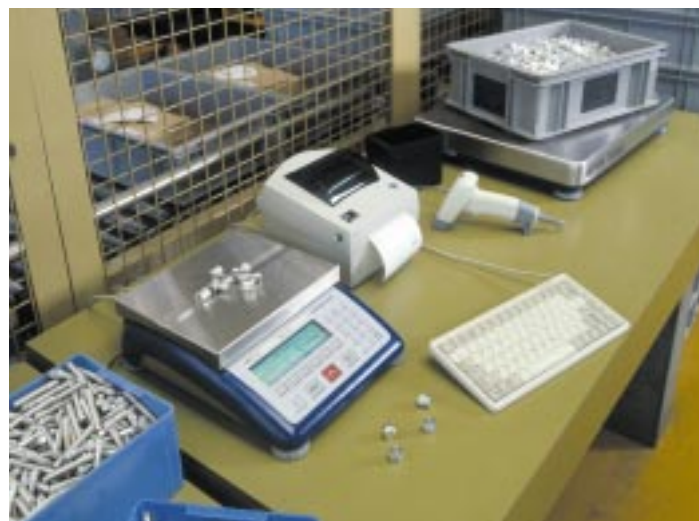
Sistema a due bilance: Viper SC come bilancia di riferimento e piatto analogico come bilancia di quantità
