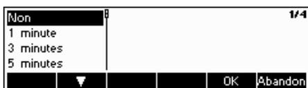
Le terminal s'éteint automatiquement lorsque le temps sélectionné est écoulé.
