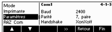
Remontez d'un niveau dans le menu en appuyant sur la touche **Retour**, puis sélectionnez ' Paramètres'. Vous pouvez maintenant définir les paramètres de vitesse ('Baud'), de parité et de contrôle de flux ('Handshake'). Vous trouverez les données correctes dans le manuel d'utilisation de votre imprimante. Dans notre exemple, les valeurs ont été déterminées comme dans l'écran présenté à gauche.
