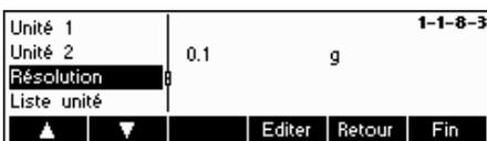
Pour changer les paramètres de la résolution de la balance, sélectionnez 'Résolution' (cette fonction n'est pas disponible sur tous les modèles).
