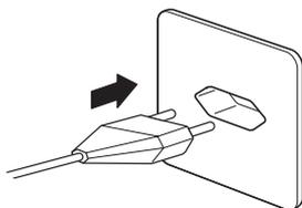
Avant de brancher le câble d'alimentation ou l'adaptateur secteur (version AccuPac), vérifiez que la tension mentionnée sur la plaque signalétique est identique à la tension d'alimentation du secteur.
