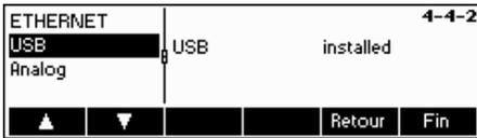
L'état de l'option USB s'affiche. Il n'y a pas d'autre configuration de l'interface USB dans Configuration Vision.
