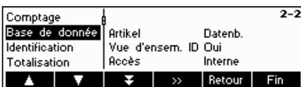
Appuyez sur '>>' pour accéder au menu des paramètres base de données. Sélectionnez l'article à modifier à l'aide des touches '▼' et '▲'. Lorsque l'article souhaité est mis en sur brillance, appuyez sur '>>' pour le modifier.
