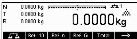
La mise sous tension du terminal déclenche un test d'affichage au cours duquel tous les segments et la version du logiciel s'affichent brièvement. Dès que le zéro apparaît sur l'affichage, le terminal est prêt à fonctionner.
