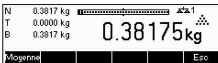
La touche permet d'afficher le résultat de la pesée en mode contrôle, c'est-à-dire avec une résolution supérieure.
