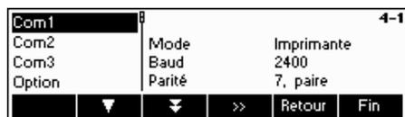
Sélectionnez dans le menu 'Configuration Vision', sous 'COMMUNICATIO', le port COM auquel vous avez raccordé votre imprimante. Dans notre exemple, il s'agit du port COM 1 (COM1). Appuyez sur la touche **>>**.
