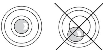
Tournez les pieds réglables pour placer la balance à l'horizontale. Si un niveau à bulle est présent, la bulle d'air doit se trouver au centre du niveau.
