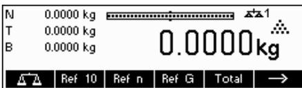
La balance effectue un test d'affichage (chapitre 1.4). Dès que l'affichage du poids apparaît, la balance est prête à fonctionner et est automatiquement mise à zéro.
