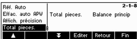
Si le paramètre 'Totalisation pièces' est commuté sur 'Balance princip.', seul le résultat de comptage de cette balance sera indiqué (standard). Si le paramètre 'Totalisation pièces' est commuté sur 'Deux balances', la quantité de référence utilisée pour la détermination du poids unitaire est additionnée au résultat de comptage.
