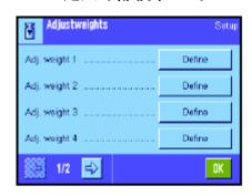
如果您正在用外部校准砝码进行工作,则这个设置可以用来定义其属性。在这两个菜单页上可以定义最多5个外部校准砝码。在校准过程中(见第7.4.3节),您将能够选择您想用来进行校准的规定砝码。
