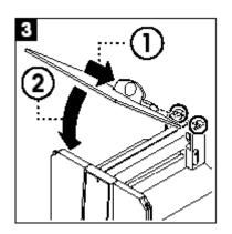
以一定角度(略小于30度)将防风罩的顶门插入定位在背部的导杆中,并小心地向下旋转防风罩门(参见图3)。
