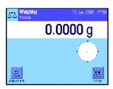
**开启天平:** 通过短按"**On/Off**"键开启天平。开启后,天平装入上次使用的用户界面和开启天平时激活的应用程序。应用程序和用户界面显示在显示屏的左上角。
