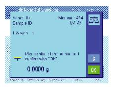
等到天平要求你装载第一个样品的称量容器(皮重)。当你完成了这一动作时,按下"OK"。在天平测定皮重的同时,会显示一条对应的报文。
