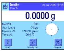
如果您使用水或乙醇以外的不同辅助液体,则激活"Density AL"功能键,并使用这个键输入您在当前温度上使用的辅助液体的密度(以g/cm3为单位,最多5个小数位)。必须执行这一操作,因为天平只存储水和乙醇的密度表。输入的值显现在具有相同名称的信息区域中,必须另外激活这些字段。注意: 如果您正在使用水或乙醇以外的不同辅助液体,则不需要使用左边示例中激活的"Temp. AL"功能键,以及具有相同名称的信息区域。但如果您需要,也可以用这个功能键输入当前环境温度,使之打印在作为测定密度的温度记录的报告上。
