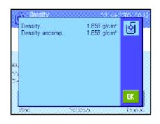
天平此时开始测定液体的密度并显示结果。根据您对结果显示屏所做的设置,或显示补偿结果、或显示未补偿结果或同时显示二者(参见第12.3.5节)。
