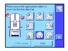
水平调节助手将显示红箭头,指示需要转动天平背部的两个水平调节脚的方向。
