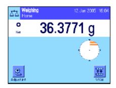
**称量:** 将称量样品放在秤盘上。稳定性检测图标(质量显示屏左侧的小环) 一变暗,显示屏即稳定并可以读取称量结果。在左边图中,稳定性检测图标仍然可见,因此称量结果尚未稳定。
