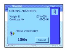
将要求的校准砝码放到秤盘上后,即开始自动执行校准操作。在校准操作结束时,将提示您拿起砝码。将校准砝码从秤盘上取出。
