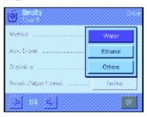
"Water": 在10°C至30°C间的不同温度上的蒸馏水密度
