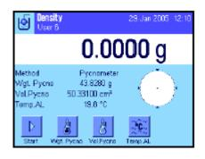
在具体应用程序设置中,选择"**Pycnometer**"( **比重瓶**)作为称量方法(见第12.3.2节)。
