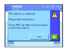
当水平传感器检测到天平度不正确时,将显现左边的警告文本并发出警告嘟嘟声。此外还将在显示屏的右上角显现一个状态图标(在时间下面)。
