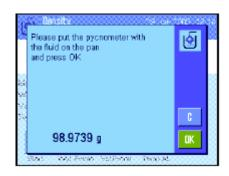
按"Start",功能键以开始密度测定。然后天平将提示您放置充满液体的比重瓶(选定比重瓶的质量显现在窗口的左下角上并带一个负号)
