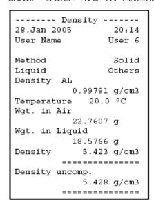
左边显示的是一个关于**固体密度测定**的报告示例。打印在报告上的信息由您在"Protocol"(报告) 菜单中所做的设置而确定(见第12.3.8节)。
