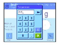
如果您用水或乙醇作为辅助液体,则用"Temp. AL"功能键输入其温度。(这两种液体在10°C至30°C的温度范围内的密度表存储在天平中,另请参阅第12.7节和第12.8节)。 左边的显示屏显示了对应的输入栏(以°C为单位输入,带1个小数位)。如果您使用水或乙醇以外的辅助液体,则激活"Density AL"功能键,并使用这个键输入您在当前温度上使用的辅助液体的密度(以g/cm3为单位,最多5个小数位)。必须执行这一操作,因为天平只存储水和乙醇的密度表。输入的值显现在具有相同名称的信息区域中,必须另外激活这些字段。注意:使用水或乙醇以外的辅助液体时,不需要使用左边示例中激活的"Temp. AL"功能键,
