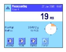
继续进行工件计数,并将附加工件放在秤盘上。要优化参考值,请按"Ref.Opt"功能键。秤盘中的件数此时被用作新计件参考值,并在此基础上重新计算参考件质量。
