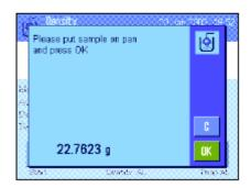
按"**Start"**功能键以开始密度测定。天平执行一次自动皮重操作, 然后提示您将固体放在天平上,以便在空气中称量。
