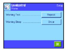
如果已激活水平传感器,则可以通过按"**Define**"按钮来规定是否及 多长时间应在天平不精确处于水平状态时显现一个警告文本和/或 发出警告嘟嘟声。
