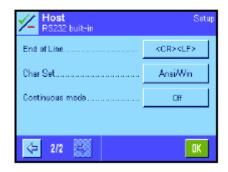
特殊设置选项可用于这些设备中的每一个的接口: "Off"表示不应连接此类设备。"RS232 fix"表示出厂时内置的RS232C接口。如果存在其他任选接口,也将显示出来(例如左边示例中的第二个串行接口"RS232 Option")。然而,此时只解释出厂时内置的RS232C接口的参数。**重要说明:**每一个可用接口只能激活一台设备。所有其他设备均须关闭("Off")。 如果您激活一台新设备,先前选择的设备将自动关闭。
