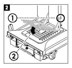
从前面插入网格秤盘。 检查网格秤盘是否正确挂在两侧上。
