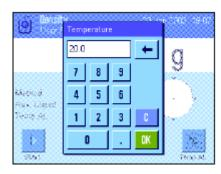
如果您用**水或乙醇作为辅助液体**,则用"**Temp. AL**"功能键输入其**温度** 。(这两种液体在10°C至30°C的温度范围内的密度表存储在天平中,另请参阅第12.7节和第12.8节)。 左边的显示屏显示了对应的输入栏(以°C为单位输入,带1个小数位)。
