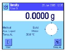
选择应用程序后, 将显现左边所示的显示屏。出厂时,已激活一 些专用功能键和密度测定用信息区域。已预置天平用水作为辅助 液体来测定密度。然而,您可以根据自己的需要,按下面各节中 的描述来修改这些设置。
