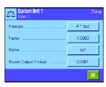
自定义称量单位可以在"Custom Unit 1"和"Custom Unit2"两个菜单中规定。 一旦称量结果被记录即可立即进行计算(如对于表面或体积)。自定义称量单位可用于所有菜单和可以选择称量单位的输入字段中(但在手动输入皮重值时不可用)。
