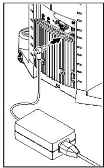
天平配有一个交流适配器和所在国专用电力电缆。交流适配器适用于下列范围内的所有电源电压:
