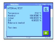
在成功完成校验后,左边的窗口显示为确认。如果将一台打印机与 天平相连,将根据用于打印的系统设置中选定的规格,自动打印校 验结果(见第5.3.7节)。打印输出实例可以在第7.4.6节中查找。
