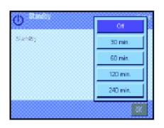
您可以关闭待机模式("Off")或者规定30, 60, 120或240分钟的时间,之后天平应进入"待机"模式。"待机"模式是用«On/Off» 键关闭天平时天平所进入的相同状态。按«On/Off»键可再次开启天平。
