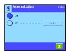
如果您正在用外部校准砝码进行工作,则这个设置可以用来规定天平应提供校准提示的天数和时间。关于用外部校准砝码(自动)执行校准过程的信息可以在第7.4.3节中查找。
