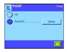
全自动校准的设置可用**内部**校准砝码(ProFACT)在该菜单中进行规定。ProFACT (**专业全自动校准技术**)提供基于预先选择的时间和/或温度标准的全自动平衡校准。
