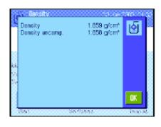
天平此时开始测定粘稠物质的密度并显示结果。根据您对结果显示 屏所做的设置,或显示补偿结果、或显示未补偿结果或同时显示二 者(参见第12.3.5节)。
