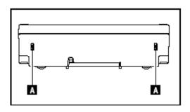
要改变阅读角,请按入显示操作终端背部的两个按钮(A)。 然后可以向上或向下拉显示操作终端顶部直到其啮合到所 需位置上。共有3个校准位置可共选用。
