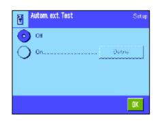
如果您想用一个外部校准砝码来校验校准结果,则这个设置可以用来规定天平应提供校验提示的天数和时间。关于用外部校准砝码 (自动)进行校验或校准过程的信息可以在第7.4.5节中查找。
