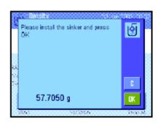
按"**Start"** 功能键以开始密度测定。天平然后提示您安装液体密度测量块(在空气中称量以定皮重)。
