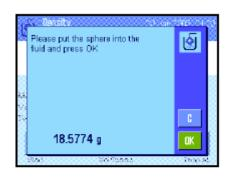
扣除样品皮重后天平将提示您将γ球浸入样品物质中。 被γ球排开的物质的质量显示在窗口的左下角中。
