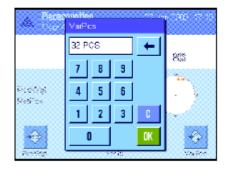
如果您已将不同于"FixPcs"键的数目的参考件放在秤盘上 (如, 32件),请按"VarPcs"(可变件数)功能键。显现一个输入栏, 您可以在其中输入件数。
