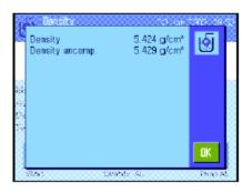
天平此时开始测定固体的密度并显示结果。根据您对结果显示屏所做的设置显示补偿结果、未补偿结果或同时显示二者(参见第12.3.5节)。
