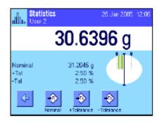
一旦标称值和公差已输入,一个带公差标记的图形称量辅助工具 ("SmartTrac")即显现在显示屏中,从而可按标称值简化称量。 如有必要,您可以大致称量样品直到出现较低的公差值然后再精确 计量至标称值。
