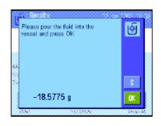
在扣除液体密度测量块皮重后,天平将提示您将要测定其密度的液体倒入一个容器中。如果您正在处理任选密度组件,则按照该组件的随带说明书进行操作。如果您正在处理天平下的吊钩,请将装有液体的容器放在吊钩下。
