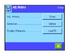
天平始终记录所有已进行的校准操作并将它们保存在一个存储器中以防断电。在这个菜单中您可以查看这些操作的列表,并规定该列表应包含哪一类校准操作以及应如何详尽列出。
