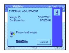
按这个功能键可触发天平用外部校准砝码进行校准。这一操作可以 随时执行,此外还可以在系统设置中规定天平在特定周日的特定时 间发出一个校准提示(见第5.3.3节)。注意:根据所在国专用法 规,用外部砝码进行的校准不可在合格天平上使用。
