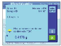
当天平已经测定出皮重时,就要求你开始称量。为了执行称原重,将称量样品装到容器内,然后按下"OK"。 在天平测定质量的同时,会显示一条对应的报文。
