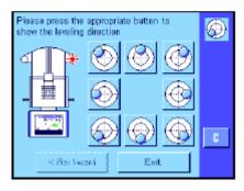
密切观察天平上的水平指示器 (打开水平传感器时将点亮) 并按与 水平指示器中的当前气泡位置一致的按钮。
