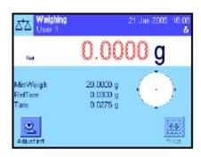
按《 $\rightarrow$ 0 $\leftarrow$ 》键将显示设置为零。将皮重(称量容器) 放在秤盘 上并按《 $\rightarrow$ T $\leftarrow$ 》键以称天平皮重。天平测定皮重值,并将其显示 在 "Tare" 信息区域中。"**Net**"图标 (净重)显现在称量显示屏旁 边。
