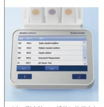
イオン測定法で一般的に使用される増分法がメニューより選択できます。増分法では標準液の加減やサンプルの加減法が含まれています。
