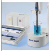
メトラー・トレドのオプションアクセサリ、uMix™マグネチックスターラーは、メソッドの自由度を与えます。撹拌はメソッドの中で測定、待機のステップで個別に設定することができます。サンプル粘度やサンプル容器に適した撹拌スピードを設定することが可能です。
