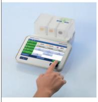
本機は様々なレベルで、校正をサポートしています。固定された校正の手順のメソッドで、校正結果を自動的に評価します。また、センサの使用度合いと校正のインターバルをモニタリングします。ロンドリーノサンプルチェンジャーとの組み合わせで、自動校正も可能です。
