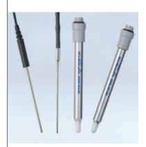
SevenExcellence™は柔軟な温度信号の入力機能を備えています。電極に内蔵されている温度センサ、もしくは、外部温度センサを使用した温度信号入力が可能です。また、手動での温度入力も可能です。
