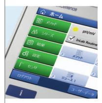
ショートカットを1回クリックするだけで、シリーズまたはメソッドを開始できます。メソッド動作中に他のメソッドを開始した場合、次の分析は、タスクリストに保持され、直前のタスクが終了してから自動的に開始されます。
