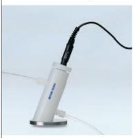
低導電率の測定には、特別な注意が必要です。純水または超純水を測定する場合、空気中の二酸化炭素や温度の不正確性といったエラー要因がいくつかあります。弊社のデジタル導電率センサ InLab® Trace は高い温度精度とオプションのフローセルを備えているため、低導電率の正確な測定に最適です。
