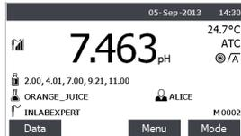
Durch Drücken von **Modus** können Sie den Modus wechseln: pH, mV, rel. mV.
