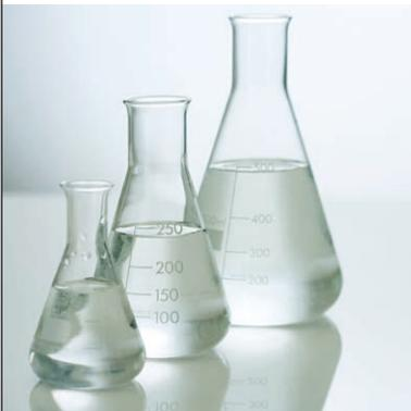
Ionenkalibrierstandards mit hoher Genauigkeit sind in den Konzentrationen 10, 100 und 1000 mg/L (ppm) erhältlich. Sollten Sie eine niedrigere Konzentration benötigen, können Sie diese einfach mit einer Verdünnungsreihe herstellen, die im Elektrodenhandbuch beschrieben ist.
