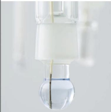
Dank des ARGENTHAL™ Referenzsystems werden die meisten pH-Sensoren von METTLER TOLEDO mit einer KCl-Elektrolytlösung mit einer Konzentration von 3 mol/L gefüllt. Es besteht keine Gefahr, dass Ihre Proben mit Silberionen verunreinigt werden. Für Messungen in nicht wässrigen Lösungen oder für die Messung von Proben mit geringer Ionenstärke ist ein spezieller Brückenelektrolyt erforderlich. Vergewissern Sie sich stets, dass Ihr Sensor vollständig mit sauberer Elektrolytlösung gefüllt ist.
