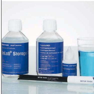
Wenn das Spülen mit deionisiertem Wasser nicht ausreicht, können Sie Probenrückstände mit einer speziellen Reinigungslösung entfernen. Abhängig von der Verschmutzung wird Pepsin-HCl oder Thioharnstoff empfohlen. Die InLab® Aufbewahrungslösung bietet für die kurz- oder langfristige Lagerung von Sensoren zwischen den Messungen optimale Bedingungen. Weitere nützliche Wartungstipps finden Sie unter [www.electrodes.net](http://www.electrodes.net)
