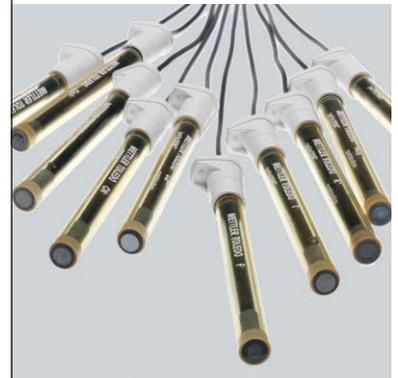
Es ist wichtig, die Referenzelektrode jeder ISE mit der empfohlenen Elektrolytlösung zu füllen. Die Verwendung des richtigen Elektrolyten minimiert Diaphragmapotenziale und bietet eine optimale Ansprechzeit. Der Elektrolyt muss regelmässig nachgefüllt oder ausgetauscht werden, um eine dauerhaft gute Elektrodenleistung zu erreichen. Weitere Informationen finden Sie im Handbuch für Ihre Elektrode.
