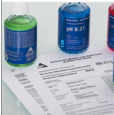
Der pH-Wert der zertifizierten Puffer von METTLER TOLEDO wird gemäss ISO/IEC 17025 durch ein von der DAKKS (Deutsche Akkreditierungsstelle) akkreditiertes Messlabor verifiziert. Aus diesem Grund sind sie die ideale Wahl für regulierte Branchen.
