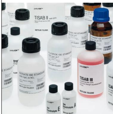
Dans toutes les procédures analytiques utilisant une ISE, il convient d'ajouter la bonne quantité d'ISA (Ionic Strength Adjustor, solution d'ajustement de force ionique) aux échantillons et étalons avant de procéder aux mesures ou calibrages. Grâce à cette solution, tous les échantillons et étalons ont une force ionique similaire et uniforme. Pour consulter le type et les quantités d'ISA requis, voir le manuel de chaque ISE.
