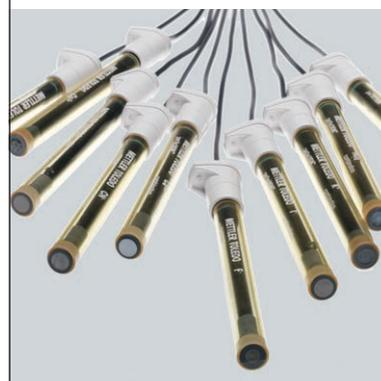
Veillez à remplir l'électrode de référence de chaque ISE avec la solution électrolytique recommandée. L'utilisation de l'électrolyte adapté permet de réduire les potentiels de jonction et de garantir une température et des temps de réponse de réponse optimaux. L'électrolyte doit être rempli ou remplacé régulièrement pour obtenir de bonnes performances d'électrode. Pour plus d'informations, consultez le manuel de l'électrode.
