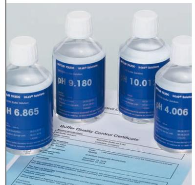
Les tampons pH NIST/DIN sont fabriqués conformément à la norme DIN/ISO 19266. Ils affichent une précision à trois décimales (p. ex. 9,180), pour une incertitude de mesure minimale. Un certificat de test détaillé est disponible pour chaque flacon. Il garantit les valeurs annoncées et la traçabilité.
