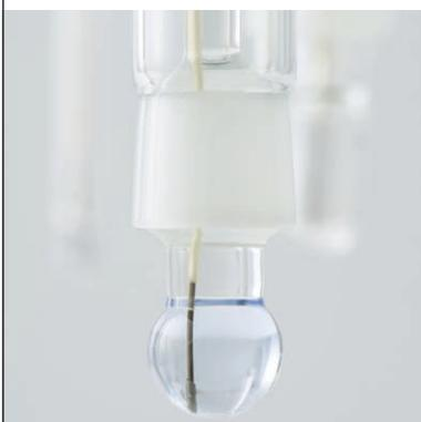
Grâce au système de référence ARGENTHAL™, la plupart des électrodes de pH METTLER TOLEDO sont remplies d'une solution électrolytique de KCl à 3 mol/L. Ainsi, vous éliminez tout risque de contaminer vos échantillons avec des ions argent. Pour les mesures dans les échantillons non aqueux ou dans les échantillons à faible force ionique, un pont électrolytique spécial est requis. Assurez-vous systématiquement que votre capteur est entièrement rempli avec une solution électrolytique propre.
