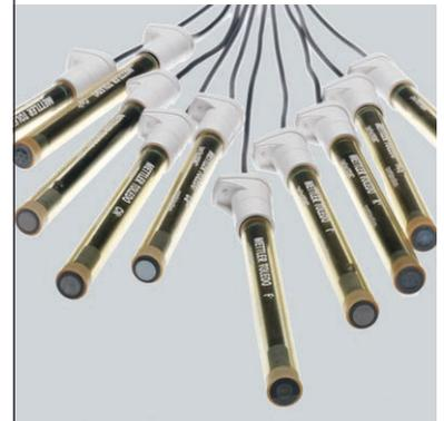
Asegúrese de llenar el electrodo de referencia de todos los ISE con la solución de electrolitos recomendada. El electrolito adecuado minimizará las posibilidades de unión y proporcionará una temperatura y un tiempo de respuesta óptimos. Debe rellenarse o sustituirse periódicamente para conseguir un buen rendimiento de los electrodos. Para más información, consulte el manual de electrodos.
