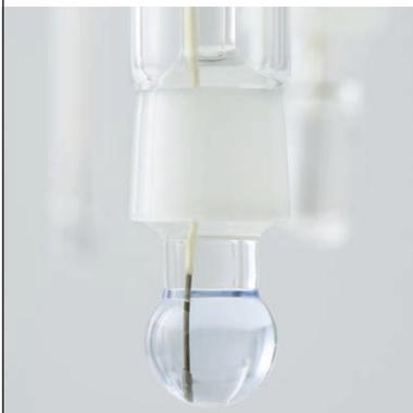
При использовании системы сравнения ARGENTHAL™ большинство датчиков рН МЕТТЛЕР ТОЛЕДО заполняется электролитом 3 моль/л KCl. Это исключает опасность загрязнения проб ионами серебра. Для анализа неводных образцов или образцов с низкой ионной силой применяются специальные электролиты для солевого мостика. Следите за тем, чтобы датчик всегда был заполнен свежим электролитом.
