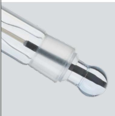
ARGENTHAL™ 比較電極システムを採用したメトラー・トレドのほとんどの pH センサには 3 mol/L の KCl 電解液が充填されています。これにより、サンプルが銀イオンで汚染されるリスクはありません。イオン強度の低い非水性サンプルの測定には、特殊なブリッジ電解液が必要です。電極に清浄な電解液が充填されていることを常に確認してください。
