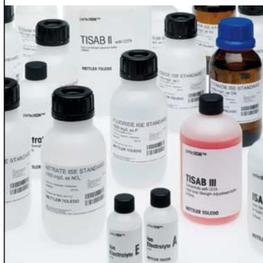
ISE を使用するすべての分析手順において、測定または校正の前に正しい量の ISA (イオン強度調整剤) をすべてのサンプルと標準液に加えることが必要です。ISA により、サンプルと標準液が同等かつ一定のイオン強度を持つことが保証されます。ISA の種類と量は、各 ISE の取扱説明書に記載されています。
