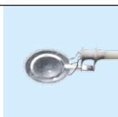
**SDTA-Sensor** bestehend aus einer Platin-Auflagefläche mit einem Thermoelement, das die Proben-temperatur misst.
