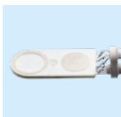
**DSC-Sensor**, aufgebaut aus 6 Thermoelementen, die unterhalb einer schützenden Keramikplatte angebracht sind, misst mehrfach die Proben- und die Referenztemperatur.
