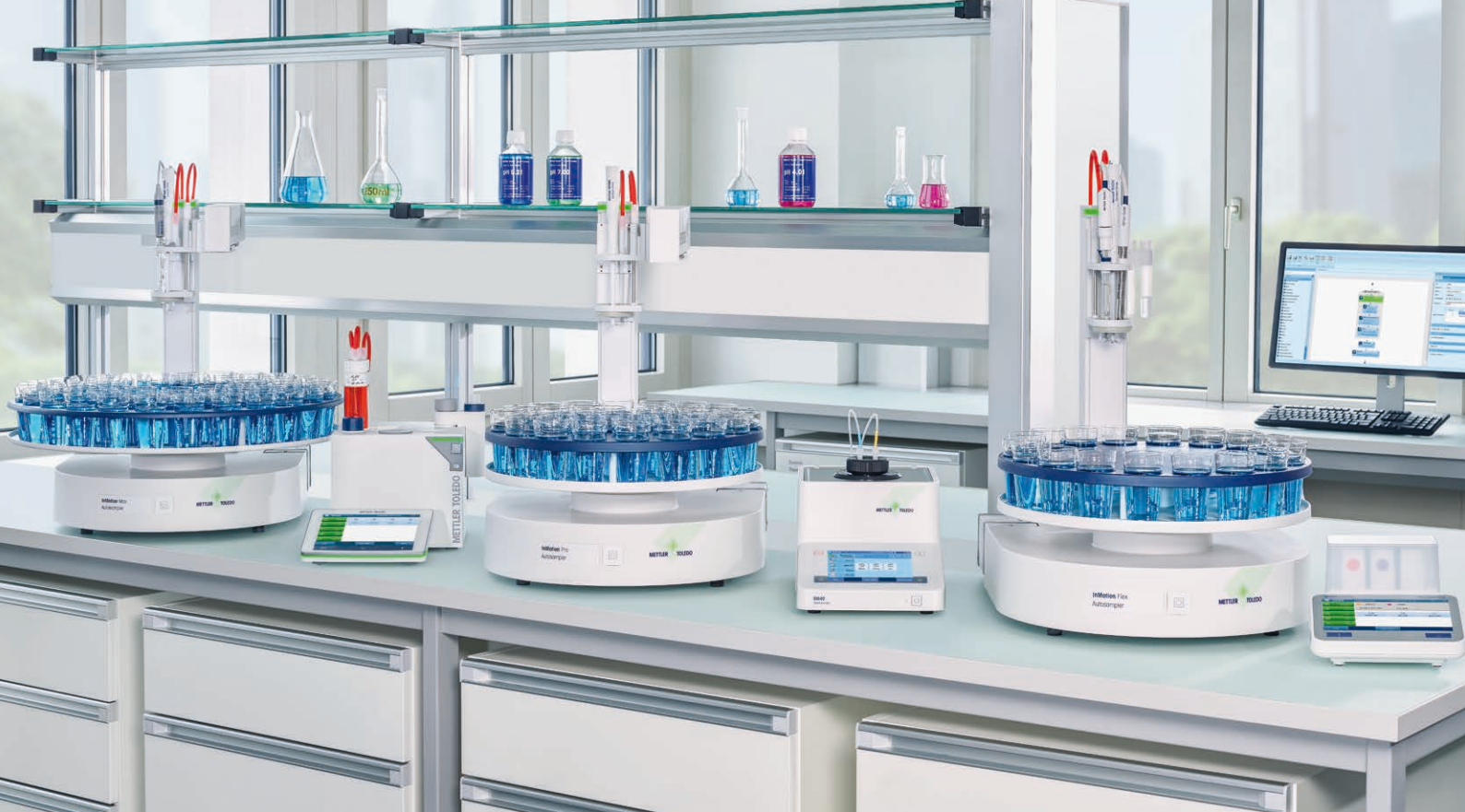
pHmetro SevenExcellence con InMotion Flex, refractómetro RM40 con InMotion Pro y valorador T9 con InMotion Max.
