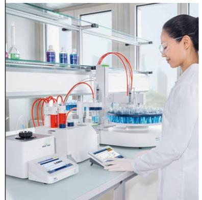
Combinez les instruments en ligne aux passeurs automatiques InMotion pour des analyses multiparamètres (p. ex., degré Brix, acidité et pH des boissons). Mesurez directement le potentiel des échantillons et envoyez les échantillons vers d'autres instruments avant ou après la dilution, tout en prélevant automatiquement des aliquotes pour le titrage.
