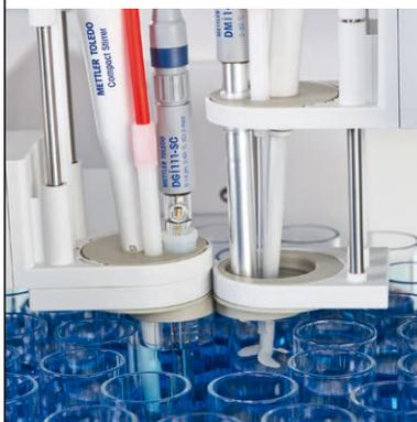
L'utilisation d'une seconde tour peut doubler le débit, tout en partageant les tâches. Utilisez n'importe quel titreur de notre gamme Excellence pour ajouter réactifs et solvants, agiter, voire chauffer un échantillon pour le préparer au titrage, pendant que la seconde tour titre l'échantillon préparé auparavant. Utilisez le titreur T90 pour effectuer des titrages simultanés sur un échantillon d'une séquence.
