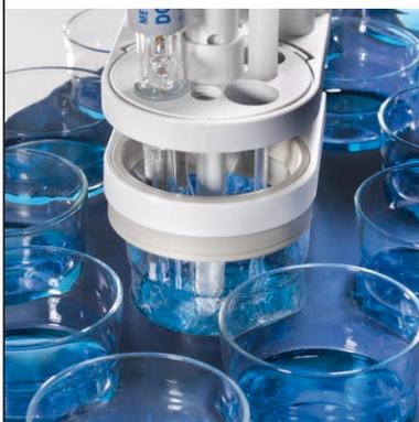
Notre système de rinçage PowerShower™ garantit le nettoyage le plus approfondi qui soit. Rincez vos inserts avec le solvant adapté, à l'aide d'une séquence de rinçage à 360 ° et puissante afin d'éliminer les contaminations. Un nettoyage supplémentaire est effectué à l'aide de béciers de nettoyage et de rinçage dédiés.
