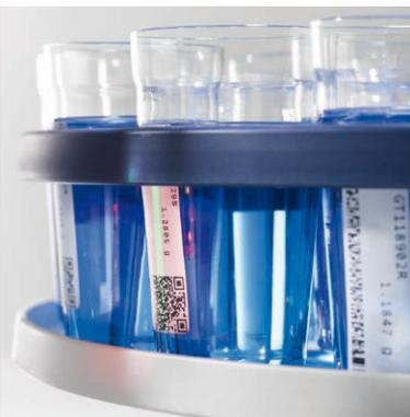
Adaptez InMotion pour qu'il lise lui-même les informations relatives à vos échantillons. Utilisez le lecteur de codes-barres pour identifier automatiquement vos échantillons. Et les LabX® SmartCodes™ qui intègrent l'information de la méthode à utiliser. Optimisez vos pesées grâce à notre technologie RFID SmartSample™ et à nos balances Excellence.
