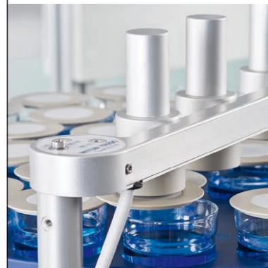
Protégez vos échantillons de l'atmosphère ou vos opérateurs des échantillons ou solvants volatils et odorants grâce à notre système de manipulation de couvercles CoverUp™. Il retire le couvercle du bécher échantillon le temps de l'analyse mais également ceux des béchers de rinçage et de conditionnement.
