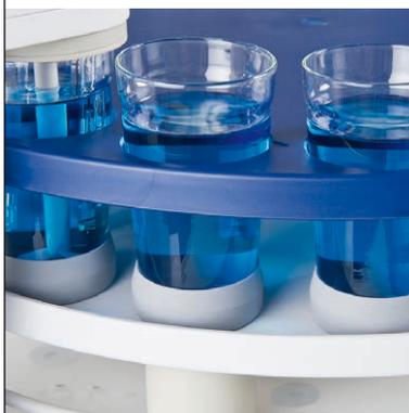
Placez simplement les échantillons sur le passeur automatique InMotion™ et démarrez l'analyse. L'instrument récupère automatiquement toutes les informations de l'échantillon à partir la puce RFID (étui réutilisable ou étiquette). Grâce au transfert sans fil des données, éliminez les erreurs de transcription et ne vous souciez plus du positionnement des échantillons.
