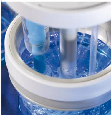
Avec le PowerShower™, un seul clic sur l'écran tactile permet de nettoyer parfaitement l'intégralité du système entre les séries d'échantillons. Une fois l'analyse de l'échantillon terminée, remettez automatiquement l'électrode de pH dans sa position initiale dans la solution de stockage qui convient.
