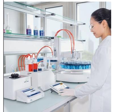
Combinare i diversi strumenti in linea con i campionatori automatici InMotion per analisi multiparametriche, ad es. grado Brix, acidità e pH nelle bevande. Misurando un parametro chiave dei vostri campioni è possibile, in funzione del risultato, inviare un'aliquota, diluita o non, alle altre fasi di analisi senza intervento dell'operatore.
