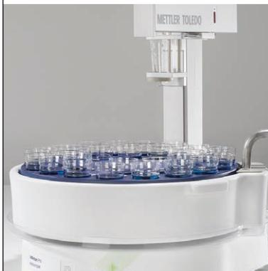
I piatti portacampioni termostatici consentono di controllare in maniera costante la temperatura di tutti i campioni nel piatto. Si raffreddano per limitare l'evaporazione di campioni volatili nel becher, si mantengono a 25 °C per accurate e regolate misurazioni di pH e conducibilità oppure si riscaldano fino a raggiungere la temperatura corporea per titolazioni pH stat che simulino le condizioni dello stomaco.
