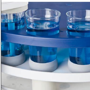
È sufficiente posizionare i campioni sul campionatore automatico InMotion™ e avviare l'analisi. Lo strumento rileva automaticamente tutte le informazioni dei campioni dal supporto RFID riutilizzabile o dal chip RFID posizionato direttamente sul becher. Grazie al trasferimento wireless dei dati non ci saranno più errori di trascrizione e non dovrete preoccuparvi di posizionare i campioni in un ordine specifico.
