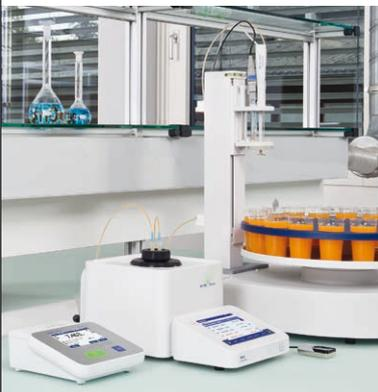
Determinate con facilità il pH e il grado Brix dei succhi aggiungendo un pHmetro SevenCompact™ al vostro densimetro o rifrattometro. Omogeneizzate automaticamente il vostro campione, grazie all'agitatore a elica, misurando contemporaneamente il pH per poi inviarlo allo strumento LiquiPhysics. Il degasaggio delle bevande addizionate di anidride carbonica è semplice ed efficiente.
