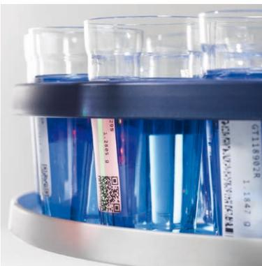
Configurate InMotion in modo tale che possa leggere le informazioni dei campioni per voi. Utilizzate il lettore di codici a barre per l'identificazione automatica dei campioni. Utilizzate il nostro LabX® SmartCodes™ per prendere le decisioni riguardanti l'analisi da eseguire sulla base delle informazioni lette. Ottimizzate i flussi di lavoro di pesata con la nostra tecnologia RFID SmartSample™ e le bilance Excellence.
