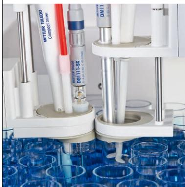
L'uso di una seconda torre può raddoppiare la produttività mediante la condivisione delle attività. Utilizzate uno dei nostri titolatori della linea Excellence per dosare reagenti e solventi, agitare e persino scaldare un campione da preparare per la titolazione mentre la seconda torre sta titolando il campione preparato in precedenza. Utilizzate il titolatore T90 per eseguire titolazioni simultanee.
