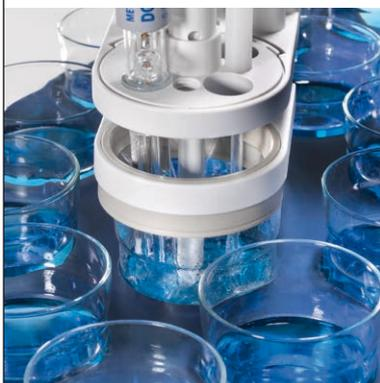
La pulizia non potrà essere più accurata senza il nostro sistema di lavaggio PowerShower™. Sciacquate automaticamente gli inserti di titolazione con il solvente appropriato grazie a una potente sequenza di risciacquo multi angolo per garantire che non vi sia contaminazione. Una ulteriore operazione di pulizia può essere eseguita mediante l'uso di una vasta gamma di becher dedicati alla pulizia e al condizionamento.
