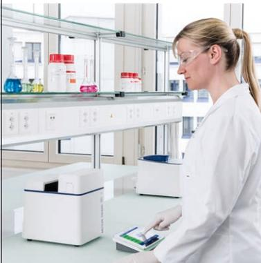
Mit CertiRef™ lässt sich die Leistung des UV5Bio schnell und einfach überprüfen. Es führt vollautomatisch Prüfungen der Auflösung der photometrischen und Wellenlängengenauigkeit sowie des Streulichts durch. Es werden zertifizierte Referenzmaterialien, die auf NIST-Primärstandards rückführbar sind, verwendet. In einem Bericht werden alle Ergebnisse dokumentiert: einfache, effiziente und sichere Prüfmittelüberwachung.
