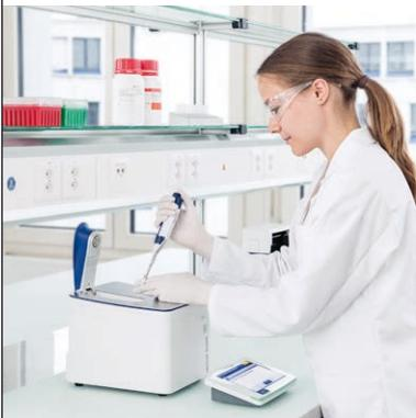
Die FastTrack UV/VIS Technologie garantiert, dass das Instrument jederzeit bereit ist. Für die Xenonblitzlampe ist keine Aufwärmzeit erforderlich, wodurch die Messzeit insgesamt verkürzt wird. Da die Lampe nur für die eigentlichen Messungen eingesetzt wird, weist sie eine hohe Lebensdauer auf.
