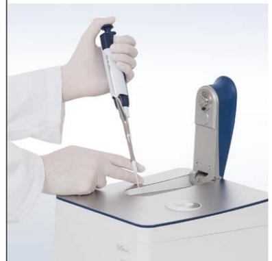
Das UV5Nano vereint zwei Instrumente für Mikrovolumen- und Küvettenmessungen in einem. Sobald sich der Arm im 90-Grad-Winkel befindet, ist die Messfläche mühelos mit einer Pipette zu erreichen, entweder von der linken oder der rechten Seite. Durch den gebogenen Deckel auf dem Instrument kann der Bediener seine Hand bequem ablegen, um die Pipettenspitze sicher zu führen.
