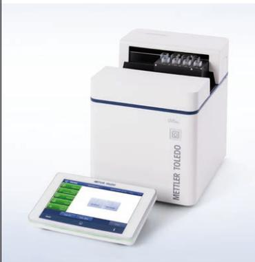
Der Probentransfer in die Küvetten-Durchflusszelle wird dank der FillPalMini Pumpe einfach automatisiert. Zudem kann die Pumpe auch zur Probenrückführung und Reinigung der Küvette verwendet werden. Mit dem Plug & Play Küvettenwechsler werden Proben inkl. Blindwertbestimmung am UV5Bio effizient analysiert, was auch die Messung von Probenserien einschließt.
