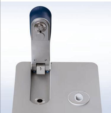
Die Mikrovolumen UV/VIS-Messung ist die Methode der Wahl, wenn kleine Probenmengen oder Proben mit hoher Absorption gemessen werden müssen. Für zuverlässige Messungen ist nur 1 µL Probe erforderlich. Die reine Probe wird mit einer Pipette auf die Messfläche aufgebracht und der Arm wird auf eine präzise festgelegte Pfadlänge automatisch verriegelt. Da die Probe nicht verdünnt werden muss, werden Fehler vermieden.
