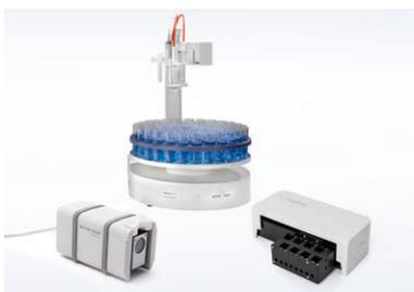
**Cuvette Changer** : jusqu'à 8 cuvettes, thermostatée avec thermostat externe (non inclus).
