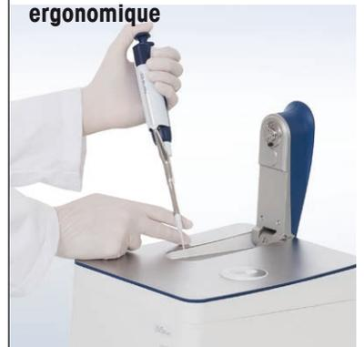
L'UV5Nano combine deux instruments en un pour les mesures de microvolumes et de cuvettes. Une fois le bras positionné en angle droit, il est très facile d'accéder à la surface de mesure depuis le côté droit ou gauche à l'aide d'une pipette. Le couvercle bombé situé au sommet de l'instrument permet aux opérateurs de bien positionner leurs mains pour guider le cône de la pipette avec précision.
