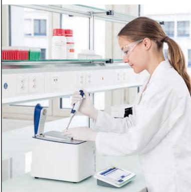
La technologie UV/VIS FastTrack™ garantit une disponibilité maximale de l'instrument. La lampe flash xénon se stabilise directement sans nécessiter de préchauffage, pour des mesures très rapides. En outre, puisqu'elle est uniquement utilisée pour les mesures réelles, sa durée de vie est considérablement accrue.
