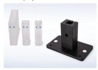
Cubetas: longitud de paso óptico de 1 y 5 cm (cristal óptico y cuarzo), microcelda de 700 µL, celda de flujo de 440 µL (cristal de cuarzo). Soportes: 1 cm de precisión, amplia longitud de paso de luz, muestra sólida y tubo.
