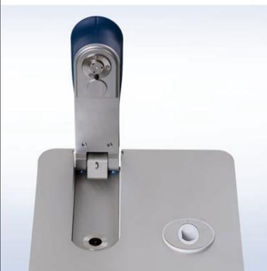
La misura UV/VIS di microvolumi è il metodo ideale quando è necessario misurare piccole quantità di campione o campioni ad assorbimento elevato. Per ottenere misure affidabili è necessario solo 1 µL di campione. Il campione puro è pipettato sulla superficie di misura ed il braccio è fissato automaticamente alla lunghezza del cammino ottico definita. Gli errori di misura vengono evitati in quanto non è necessario diluire il campione.
