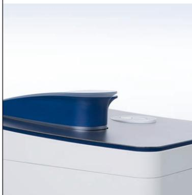
LockPath consente la misura di ampi intervalli di concentrazione da 6 a 15,000 ng/µL di dsDNA senza ulteriori diluizioni. Questo, e la realizzazione della misura entro 2 secondi, per lunghezza di cammino ottico, consentono di risparmiare tempo prezioso. Il design del braccio evita in modo efficiente l'essiccamento del campione durante la misura, il che ottimizza la ripetibilità.
