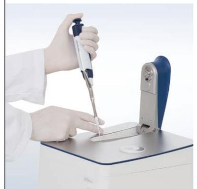
UV5Nano combina due strumenti in uno per le misure di microvolumi e quelle basate su cuvette. Una volta che il braccio si trova a una posizione di 90 gradi la superficie di misura è facilmente accessibile con una pipetta sia dal lato destro che da quello sinistro. Il coperchio curvo sulla parte superiore dello strumento semplifica il pipettaggio.
