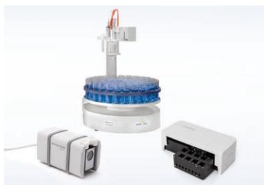
**CuvetteChanger:** fino a 8 cuvette, termostatabile con termostato esterno (non incluso).
