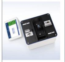
Robustez e confiabilidade excepcionais, graças à ausência de partes móveis na estrutura ótica, a lâmpada Xenon de luz pulsada de longa duração e fibras óticas de alto desempenho. A conectividade flexível com impressoras, PC, dispositivos de armazenamento e leitores de código de barras torna os instrumentos Excellence UV/VIS um investimento sólido e sustentável.
