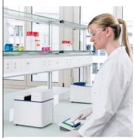
O CertiRef permite verificar rápida e facilmente o desempenho do UV5Bio. Este verifica automaticamente a resolução, precisão fotométrica e de comprimento de onda e luz difusa. Nele são usados materiais de referência certificados rastreáveis segundo a NIST e o sistema emite um relatório que documenta todos resultados obtidos. A verificação do desempenho nunca foi tão fácil, eficiente e segura.
