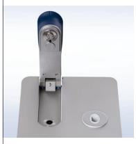
A medição de UV/VIS de microvolumes é a escolha certa para pequenas quantidades de amostras e/ou amostras de alta absorção. Apenas 1 µL de amostra é necessário para medições confiáveis. A amostra pura é pipetada na superfície de medição e a tampa ajusta automaticamente o caminho ótico definido com precisão. Os erros de medição são evitados, pois a amostra não precisa ser diluída.
