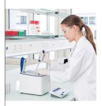
A tecnologia FastTrack™ permite medições instantâneas e garante que o instrumento esteja sempre pronto para análises. Sua lâmpada pulsante de Xenon não precisa de aquecimento para obter estabilidade, o que acelera o tempo de suas medições. Como a lâmpada é utilizada apenas no momento da medição, sua vida útil se torna ainda major.
