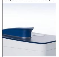
O LockPath™ permite medir amplas faixas de concentração de 6 ng/µL a 15,000 ng/µL de dsDNA sem diluições adicionais. Esta vantagem e a realização da análise em 2 segundos, economiza um tempo precioso. O design da tampa previne com eficiência a evaporação e secagem da amostra durante a medição, o que garante uma repetibilidade estável.
