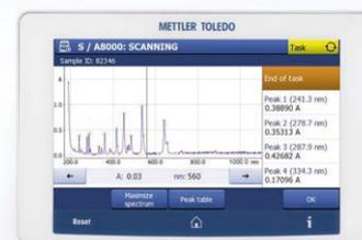
Пользовательский интерфейс понятен и удобен в работе. Большой и четкий сенсорный экран и функциональность цветов позволяют наглядно отображать спектры и результаты. Для масштабирования при рассмотрении спектра можно растянуть изображение двумя пальцами, даже работая в защитных перчатках.
