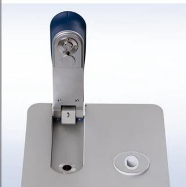
УФ-ВИД спектроскопия микро-объема подходит для образцов малого объема или с большим коэффициентом поглощения. Всего 1 мкл образца позволяет получить достоверный результат. Образец без разбавления (исключает дополнительные ошибки) наносят на измерительную поверхность, и крышка точно фиксируется на определенной длине оптического пути.
