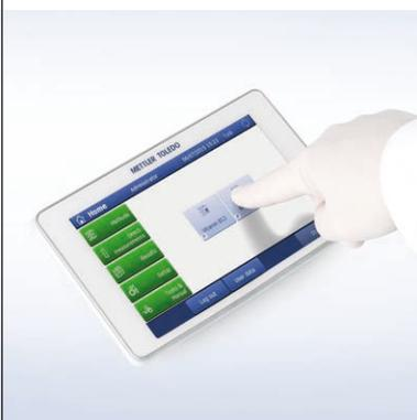
Клавиши быстрого доступа One Click на главном экране позволяют запускать прямые измерения и операции всего одним нажатием. В каком бы разделе меню вы ни находились, вернуться к главному экрану можно также одним нажатием клавиши. Настройка клавиш быстрого доступа выполняется очень просто.
