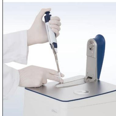
В UV5Nano совмещены два прибора – для измерений в микрообъемах и в кюветках. Когда крышка переводится в положение 90 градусов, открывается удобный доступ к поверхности измерения для нанесения образца как с левой, так и с правой стороны. Изогнутая крышка на верхней части прибора служит для удобства оператора при нанесении образца.
