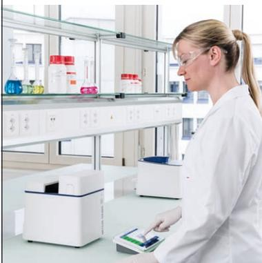
CertiRef позволяет быстро и легко проверить производительность UV5Bio. Автоматически проверяются разрешение, фотометрическая точность и точность длины волны и рассеянный свет. Используются сертифицированные эталонные материалы, отслеживаемые по стандартам NIST, и все результаты заносятся в отчет.
