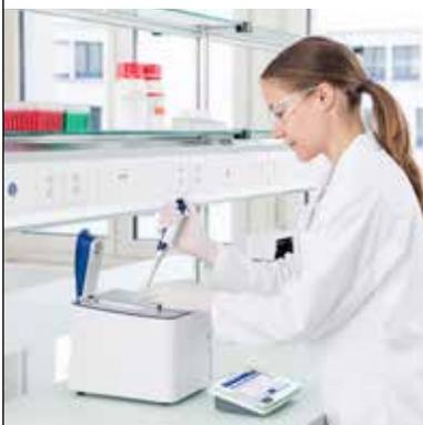
FastTrack UV/VIS技術により、機器を常に使用可能な状態に維持できます。キセノンフラッシュライトは安定化のためのウォームアップ時間が不要なため、測定がスピードアップします。ライトは実際の測定時にのみ使用されるため、長い寿命を実現します。
