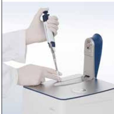
UV5Nanoは2つの機器を組み合わせ、微量測定とセルベースの測定に1台で対応します。アームを90度のポジションに置くと、左右両側から測定面にピペットを入れることができます。機器上部のカーブしている蓋により、オペレーターは都合のよい場所に手を置き、ピペットチップを安全に導くことができます。
