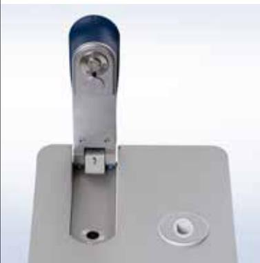
微量UV/VIS測定は、少量のサンプルまたは吸光度の高いサンプルを測定する必要がある場合に有効なメソッドです。わずか1  $\mu$ Lのサンプルで信頼性の高い測定ができます。1  $\mu$ Lのサンプルを測定面にピペティングすると、高精度の既定の光路長にアームが自動的にロックされます。サンプルを希釈する必要がないため、測定エラーを回避できます。
