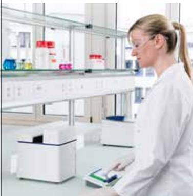
CertiRef™は、Ph.Eur.またはUSP薬局方の準拠に必要なあらゆる試験を実行します。解像度、光度/波長の正確度、迷光などを自動的に確認します。分析にはNISTトレーサブルな認証済み比較材料を使用しレポートにすべての結果が記録されます。性能検証がこれまでになく容易に、効率的に、また安全になりました。
