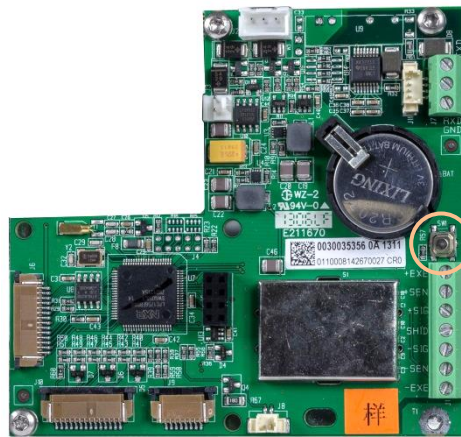
Figura 2-2: Posizione dell'interruttore per la configurazione sulla scheda madre del terminale
