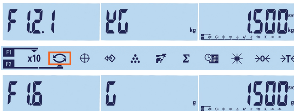
Figura 1-7: Cambio unità di misura: Da chilogrammi a grammi
