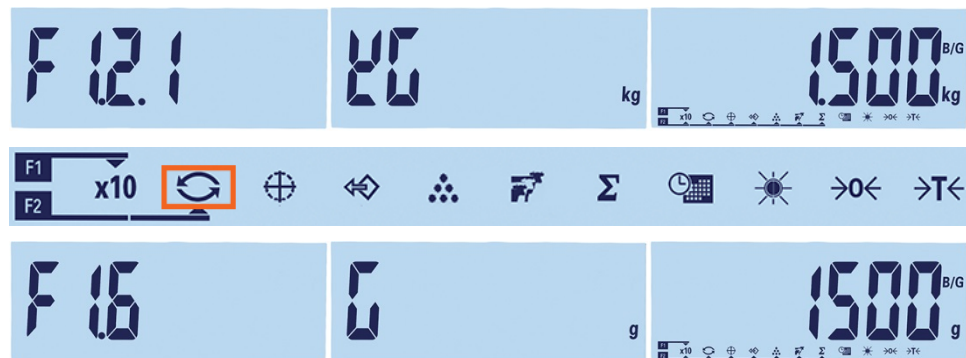
Abbildung 1-7: Umschalten der Maßeinheit: Kilogramm in Gramm
