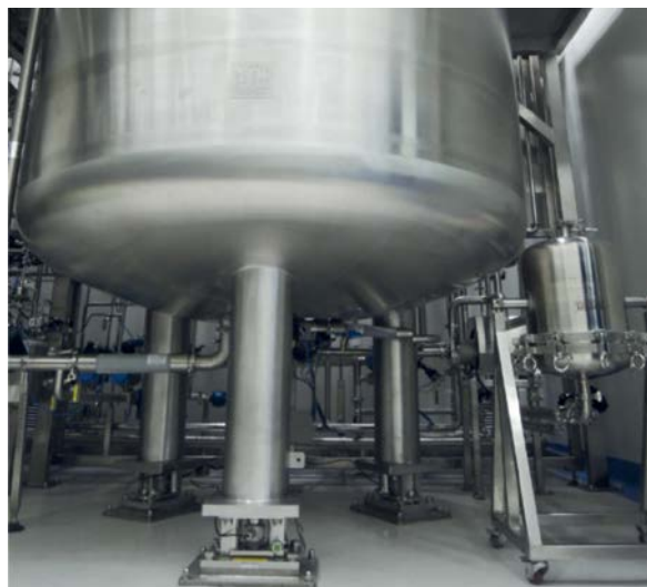
Dolní část reaktoru připevněného k flexibilním kompresním váhovým modulům
