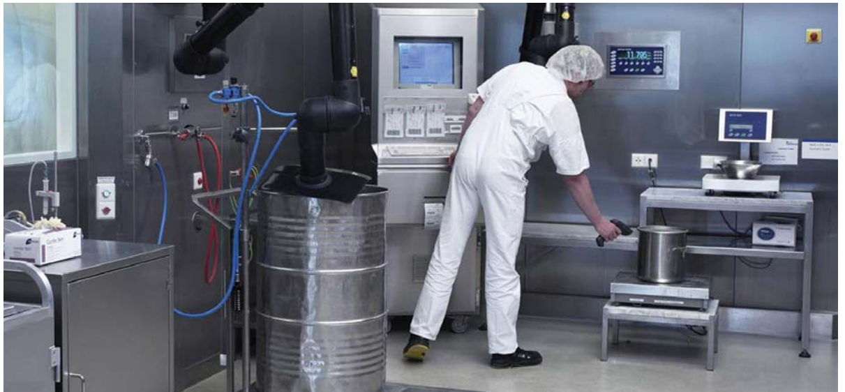
Figure 8: pesatura di materiali aggiunti a mano fuori dalla linea
