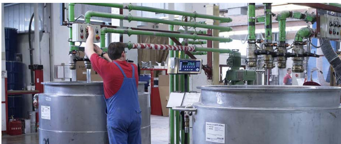
Figura 27: operazione di riempimento manuale
