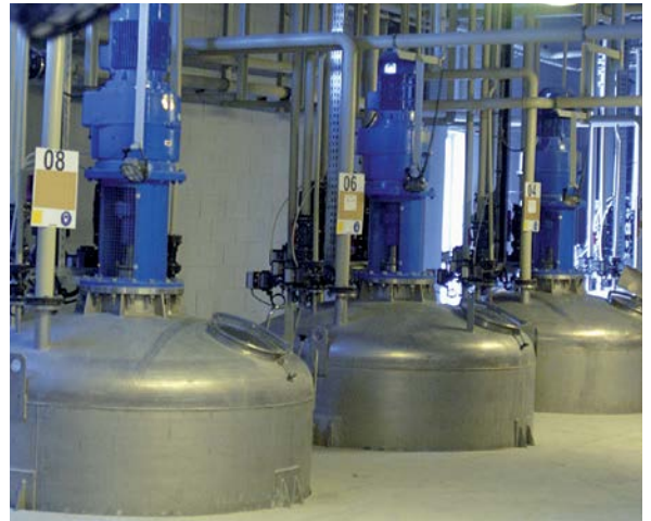
図 2: 床貫通式タンクスケール
