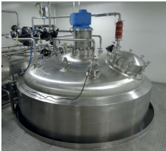
十分なスペースを確保し、次の階に達しているリアクタの上部
