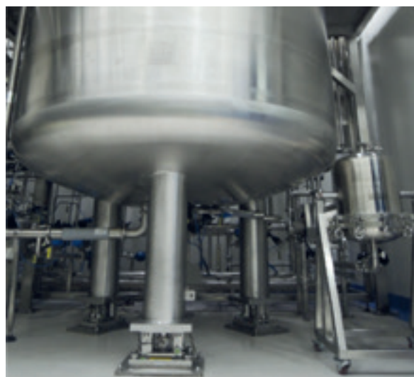
Dolna część reaktora jest zamontowana na elastycznych dociskowych modułach wagowych.
