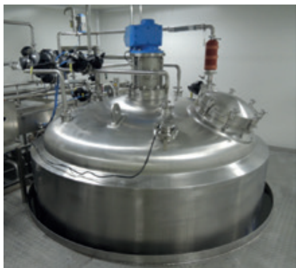
Górna część reaktora przechodzi przez otwór w suficie, z odpowiednim miejscem na ruchy reaktora.
