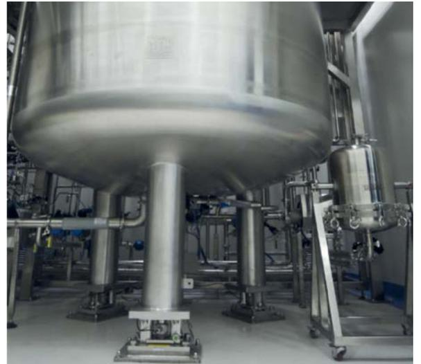
安装在灵活压式称重模块上的反应器下部
