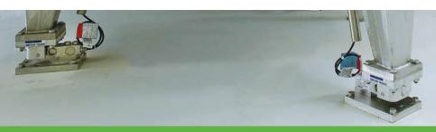
計量は、タンクの形状に左右されない、非流動性材料に適した、正確な在庫管理/製造管理メソッドです。 正確な在庫管理は材料コストの最適化につながり、材料を安全に保管し一貫した製品品質を維持することが可能になります。
