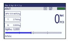
Introduzca el peso de tara conocido del contenedor. Por ejemplo, 0,48 kg. Toque 0.48 en el teclado y pulse la tecla de TARA.
