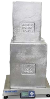
Die BC-Waage wurde für bis zu 500 % ihrer Nennkapazität geprüft.
