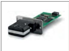
Opzione BT2: Interfaccia Bluetooth, collegamento a punto singolo con altri dispositivi Bluetooth, ad es. computer
