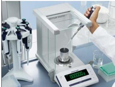
Installando la trappola anti-evaporazione, la bilancia semimicro MS può essere facilmente e rapidamente trasformata in una stazione di controllo pipette. L'applicazione integrata guida gli operatori nel processo di controllo delle pipette.
