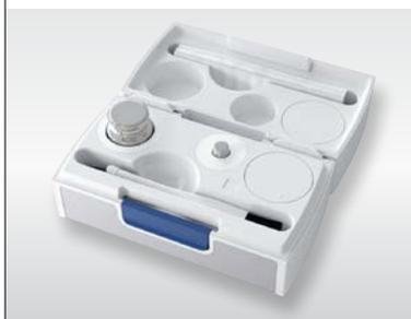
Assicurate la costante accuratezza delle pesate verificando in modo efficiente la bilancia con soli due pesi di prova: è infatti sufficiente effettuare i test al 5% e in prossimità del 100% della portata della bilancia.
