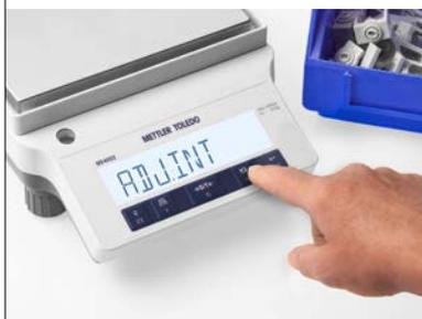
L'accuratezza viene garantita senza pesi di taratura esterni. I pesi di prova interni permettono di eseguire facilmente e in qualsiasi momento le operazioni di verifica e regolazione utilizzando un solo tasto.
