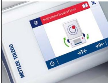
La funzione LevelControl integrata emette un allarme quando la bilancia non è in bolla e fornisce istruzioni sullo schermo per livellarla di nuovo correttamente in pochi secondi.
