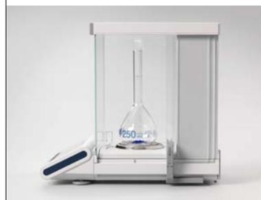
Gli sportelli separati del paravento non sporgono oltre la bilancia e permettono così di risparmiare spazio di lavoro. I connettori sul retro della bilancia sono montati lateralmente, per un accesso semplificato e un ingombro ulteriormente ridotto.
