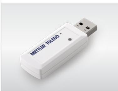
Inviare i risultati in modalità wireless dalla bilancia al PC. Si lavora così in formato elettronico senza la necessità di cavi.
