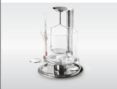
Installate sulla bilancia un kit per la determinazione della densità di campioni solidi, liquidi e porosi. L'applicazione integrata guida gli operatori nella procedura.
