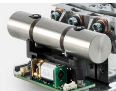
La cella di pesata con tecnologia di compensazione della forza elettromagnetica (EMFC) integra la funzionalità FACT che regola automaticamente la bilancia utilizzando i pesi interni per garantire risultati accurati anche in caso di variazione della temperatura ambiente.
