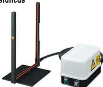
El electrodo universal independiente elimina las cargas electrostáticas de muestras y contenedores.
