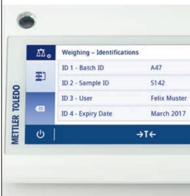
Introduzca un máximo de 4 ID por muestra, mediante la pantalla táctil integrada o un lector de código de barras, para lograr una trazabilidad rápida y fiable (p. ej., usuario, muestra, lote, etc.).
