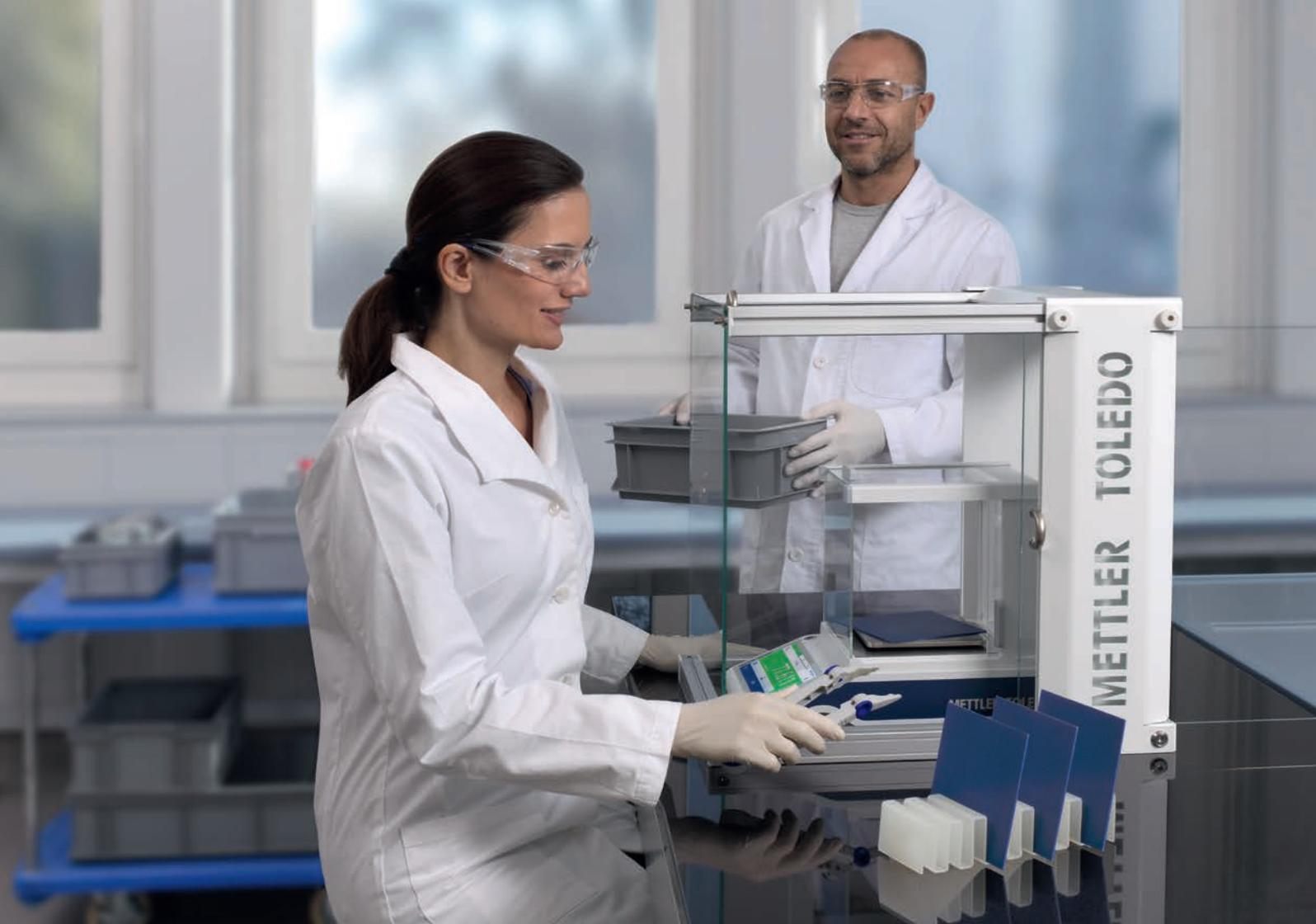
El gran cortavientos protege la balanza contra las corrientes de aire, lo que resulta idóneo para aplicaciones delicadas, como determinar el peso de los revestimientos mediante pesaje diferencial.
