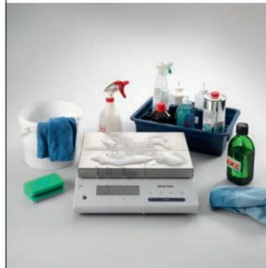
Para resistir las condiciones de pesaje más duras, las balanzas de precisión MS con plataforma grande cumplen con los requisitos IP65 para la protección total contra la entrada de polvo y líquido.
