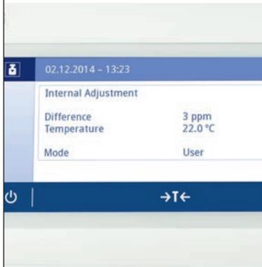
El ajuste interno de la hora y la temperatura controlado de forma totalmente automática, permite compensar los cambios en la temperatura ambiente, que pueden afectar a la precisión de los resultados de pesaje.
