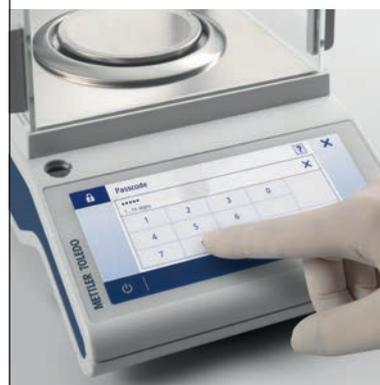
Se puede crear una contraseña para restringir la modificación de los ajustes de la balanza únicamente al personal autorizado. Las funciones que afectan el rendimiento metrológico están protegidas contra cualquier alteración accidental.
