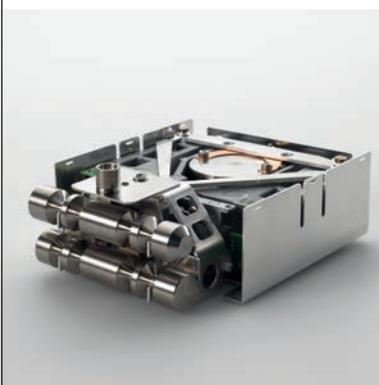
El ajuste interno de la hora y la temperatura controlado de forma totalmente automática (FACT) usa las dos pesas integradas para comprobar la sensibilidad y no linealidad, a fin de garantizar unos resultados precisos de forma constante.
