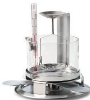
Kit dedicato per la determinazione della densità di sostanze solide e liquide con l'applicazione integrata.
