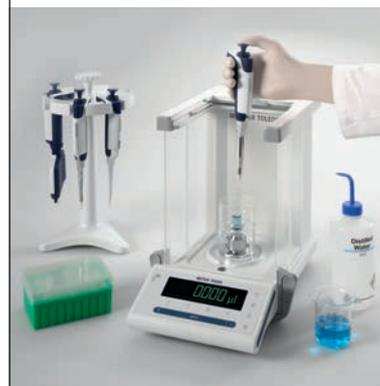
Trasformate rapidamente la vostra bilancia micro-analitica in una stazione di controllo pipette installando una trappola anti-evaporazione. L'applicazione integrata guida gli operatori nel processo di controllo delle pipette.
