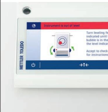
La funzione integrata LevelControl emette un allarme quando la bilancia non è in bolla e fornisce istruzioni sullo schermo per livellarla in modo corretto in pochi secondi.
