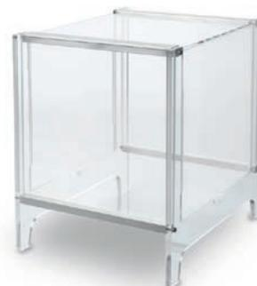
L'ampio paravento protegge la bilancia dalle correnti d'aria (ad esempio aria condizionata) che possono impedirne la stabilizzazione. Ottenete risultati più veloci e accurati.
