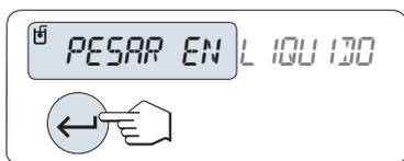
La balanza le indica que pese el sólido en el líquido auxiliar "PESAR EN LIQUIDO".
