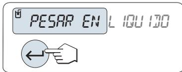
La balanza le indica que pese el dispositivo de inmersión en el líquido "**PESAR EN LIQUIDO**".
