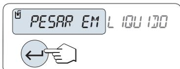
A balança avisa para pesar o sólido no líquido auxiliar "**PESAR EM LÍQUIDO**".
