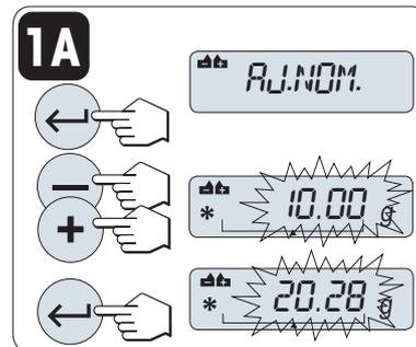
**Configuración de la referencia en modo de pesaje (pesaje del peso teórico)**
